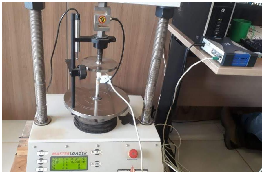
Figura 3.41. Procedimento de calibração dos sensores de imersão em laboratório.
