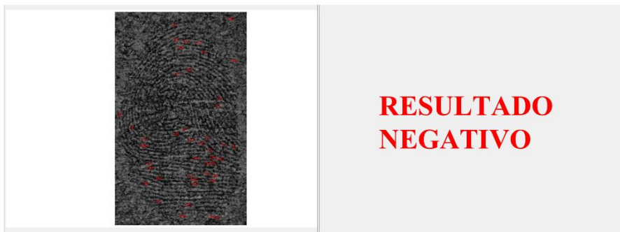
Figura 24 – Resultados de identificação pelo software VeriFinger do tipo batida/rolada. Fotos tratadas das impressões digitais latentes, da carteira de couro, do pedaço de pasta de papelão plastificado, da tesoura de metal e do pedaço de papelão (todas à esquerda), após revelação com EuBDC, com os resultados correspondentes encontrados no banco de dados do sistema (à direita).
