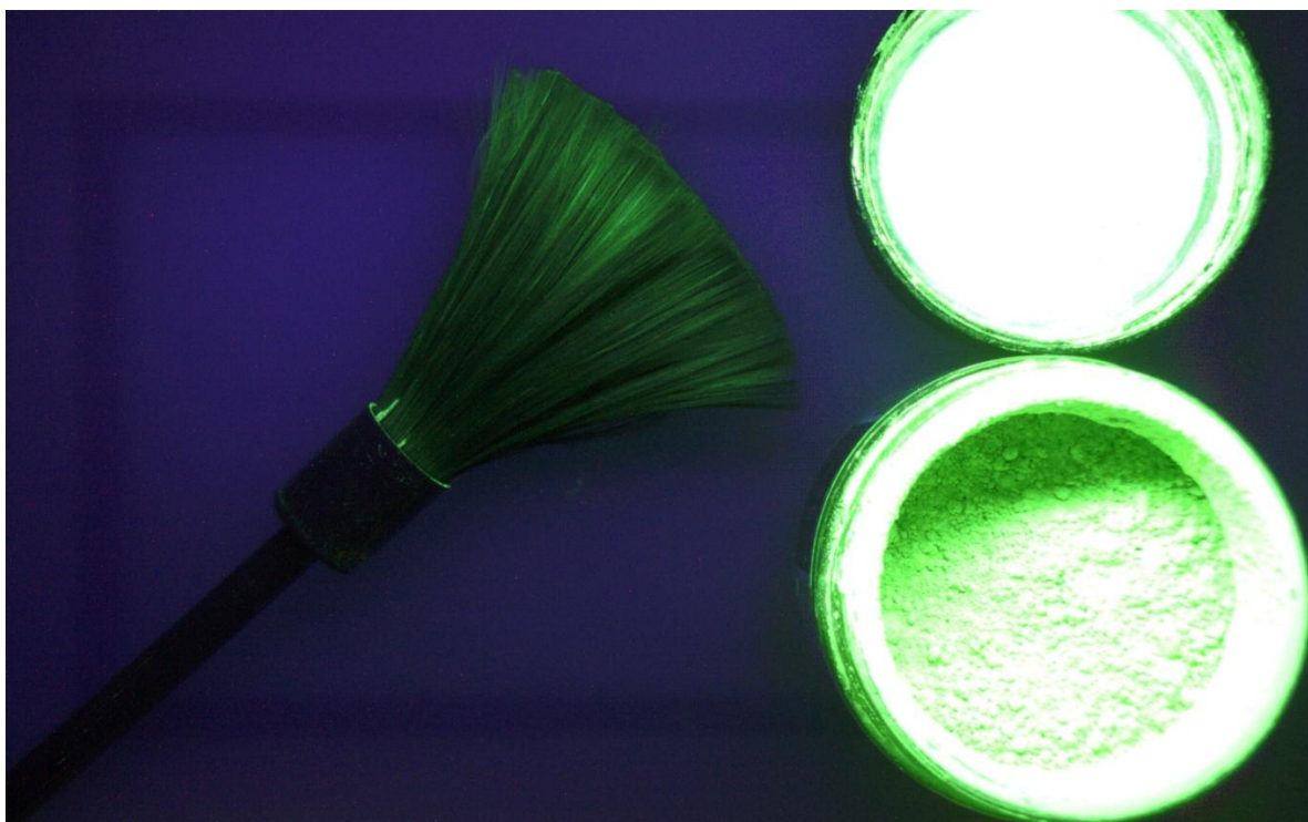
Figura 15 – Pincel de aplicação com pó fluorescente verde para revelação de impressões digitais latentes, da marca Sirchie GREENescent® sob luz UV em dispositivo de verificação de autenticidade documental Regula 4205D.03. (Fonte: autor)
