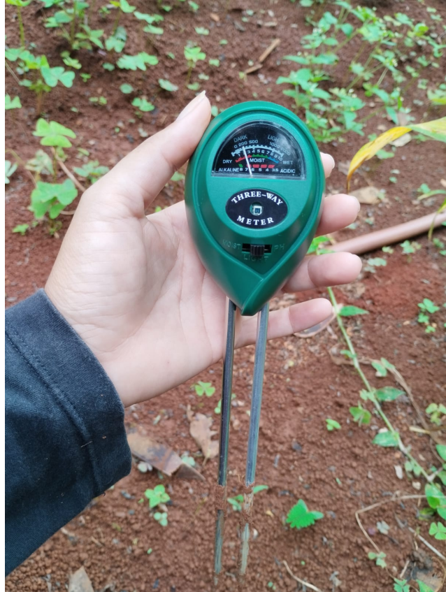
Figura 7 – Sensoriamento usado na pesquisa em campo –modelo three-way meter sensor (Fonte: a autora).
