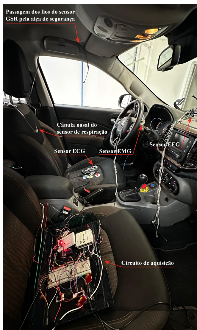
Figura 3.8. Representação da instrumentação do condutor dentro do veículo base do simulador automotivo do Centro de Pesquisa Automotiva (ARC)
