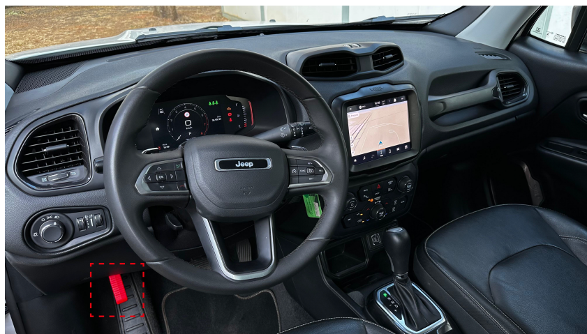
Figura 3.10. Demonstração da localização da porta OBD II do veículo teste. O OBD é indicada pela linha tracejada em vermelho, localizada na parte inferior do painel, ao lado esquerdo da coluna de direção
