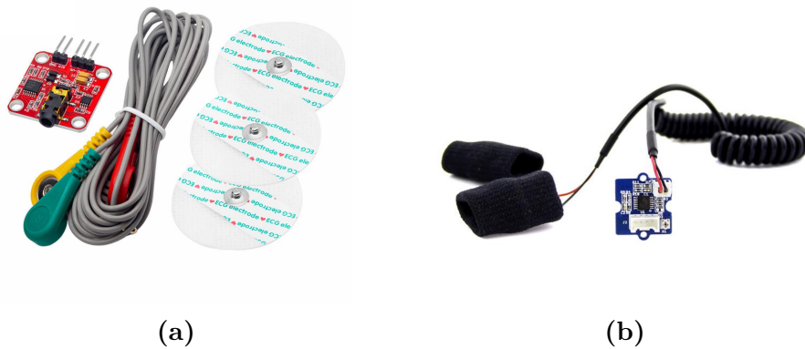
Figura 3.3. Sensores utilizados para aquisição dos sinais fisiológicos de a) eletromiografia (EMG) e b) resposta galvânica da pele (GSR).
