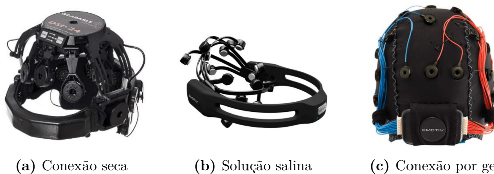
Figura 2.6. Representação dos diferentes tipos de conexão de dispositivos de eletroencefalograma (EEG)
