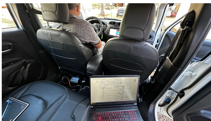
Figura 3.12. Disposição do espaço destinado ao pesquisador no banco traseiro do veículo durante a realização do ensaio
