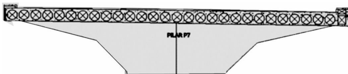
Figura 17 - Configuração do pilar original do viaduto do Eixo Rodoviário Sul (DF002) sobre a Galeria dos Estados, em Brasília. (Adaptado pela autora).
