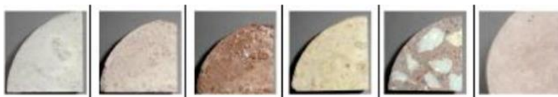
Figura 31 – Variação de cor de concretos produzidos com o cimento branco.
