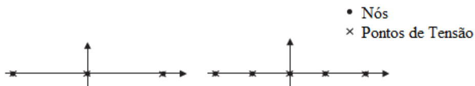
Figura 4.4 – Elemento tipo Geogrid (Manual Plaxis, 2022)
