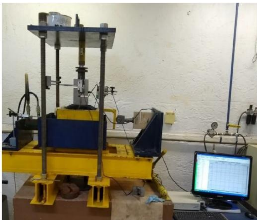
Figura 4.3 – Equipamento do Ensaio de Cisalhamento (Melchior Filho, 2022)
