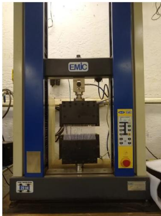
Figura 4.2 – Equipamento do ensaio de tração de faixa larga (Melchior Filho, 2022)
