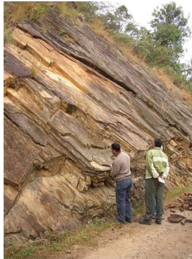
Figura 3.2 - Mecanismo de ruptura planar com susceptibilidade a conformação de mecanismos de ruptura escalonadas (Hearn, 2011).
