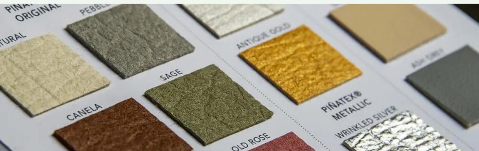
Figura 4: Piñatex, material feito a partir de folhas de abacaxi
