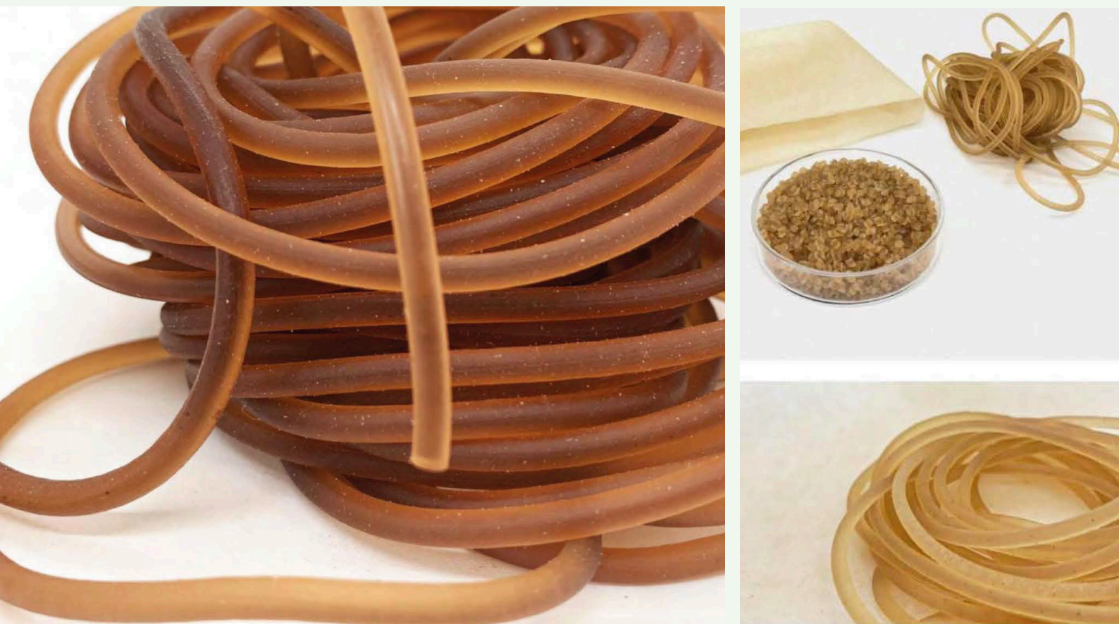
Figura 24: Qulp, utiliza biopolímeros derivados de algas vermelhas para a criação de um bioplástico totalmente compostáveis
