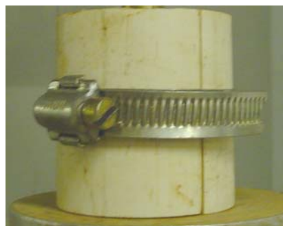
Figura 4.1 - Cilindro PVC bipartido e braçadeira metálica utilizados nos ensaios de mini-CBR e cone adaptado.
