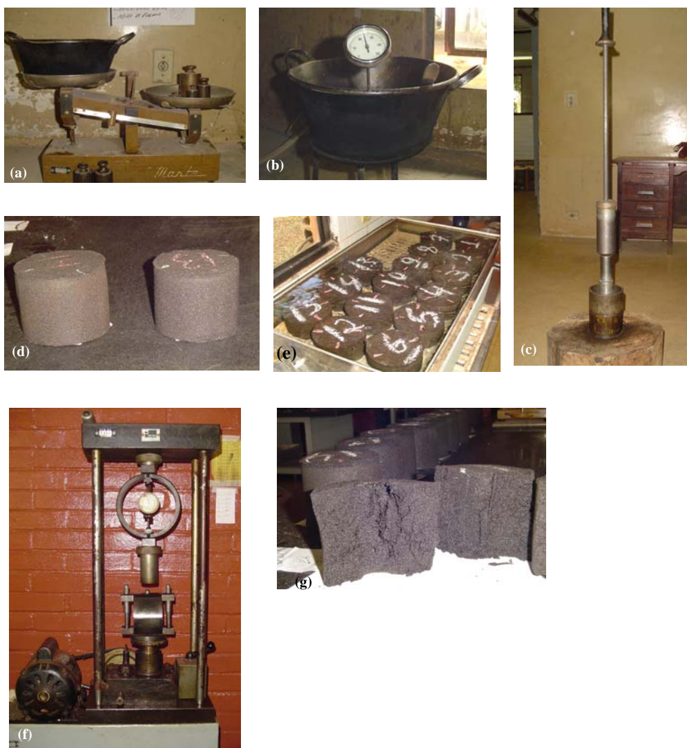
Figura 4.7 - a) Pesagem dos agregados; b) Aquecimento dos agregados; c) Equipamento utilizado na compactação; d) Corpos de prova após compactação; e) Corpos de prova no banho-maria; f) Determinação da estabilidade e fluência; g) Corpos de prova após rompimento.
