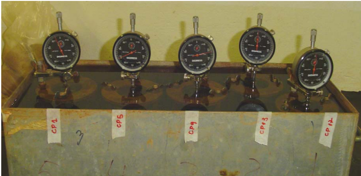
Figura 4.2 - Corpos de prova na expansão para posterior determinação de Mini-CBR pós-imersão.
