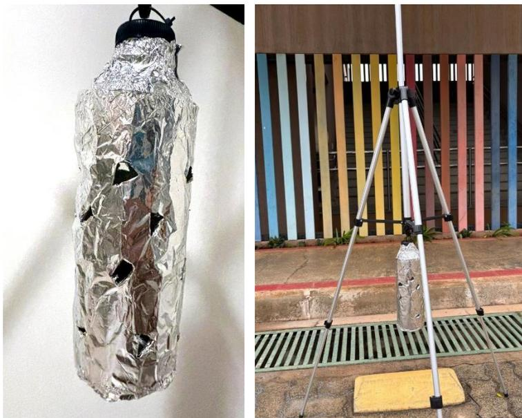
Figura 11 - Artefato protetor dos loggers e sua aplicação junto ao tripé
