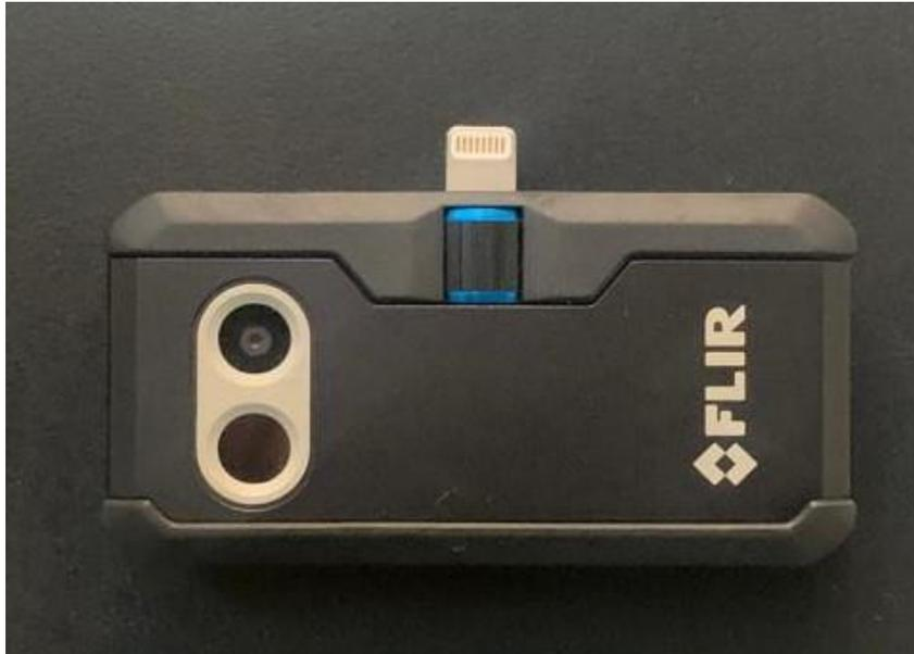
Figura 7 - Foto da Câmera FLIR One Pro utilizada
