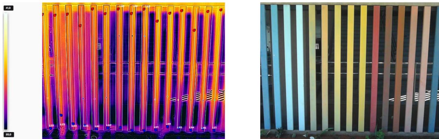
Figura 28 - Amostra de Termograma e Foto da medição de Abril às 11h
