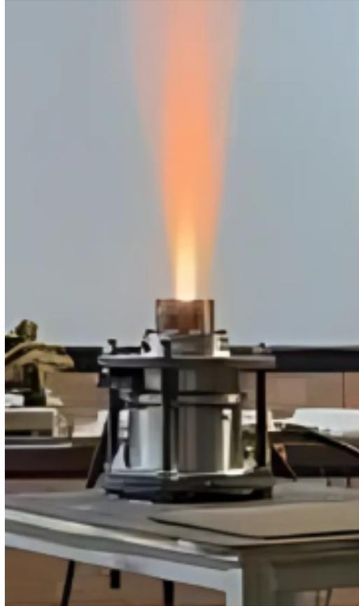
Figura 3.19 – Motor operando com PB como matriz sólida.
