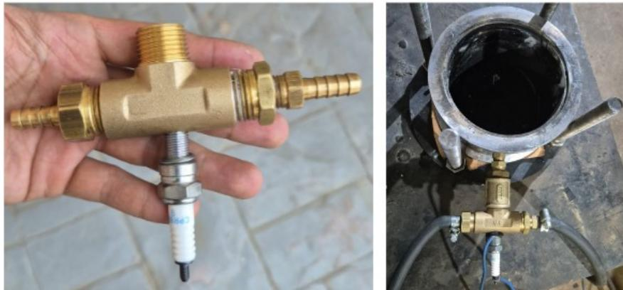
Figura 3.12 – Sistema alternativo de ignição.
