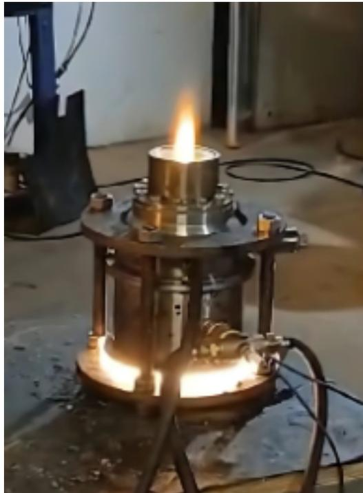
Figura 3.20 – Motor operando com PPMA como matriz sólida.
