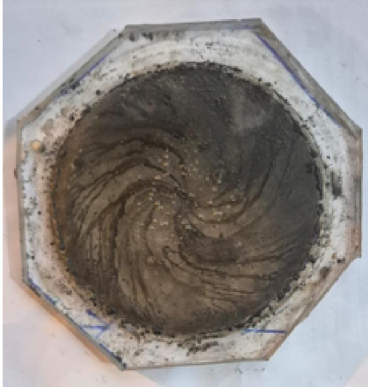
Figura 3.21 – Padrão formado na superfície sólida do PMMA.
