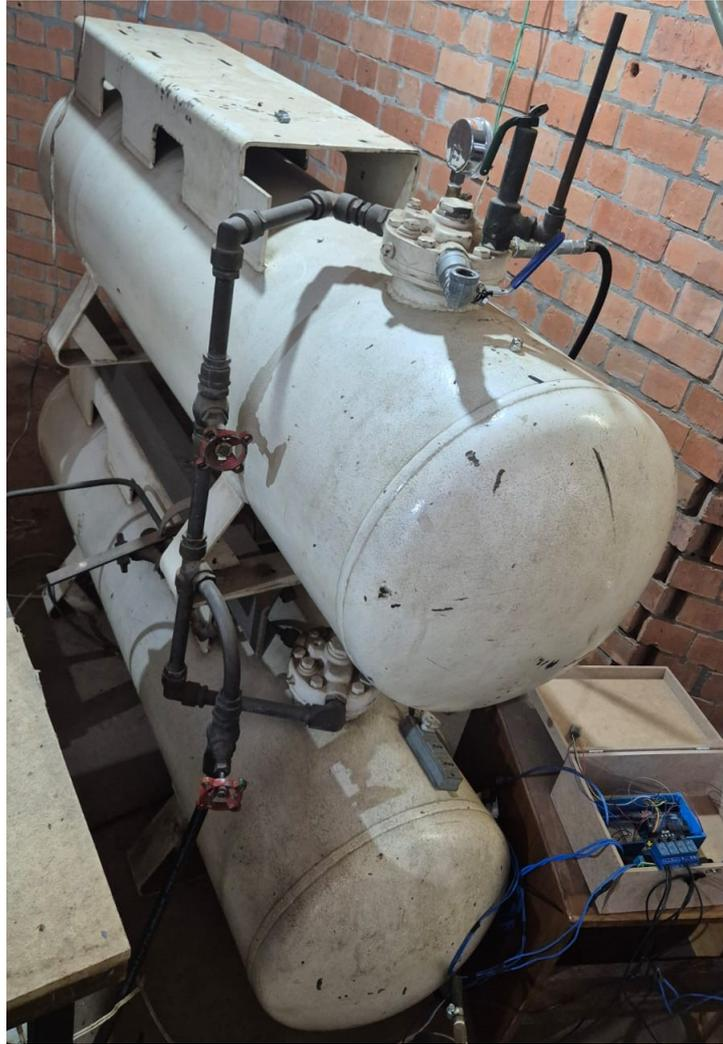
Figura A.3 – Cilindros do reservatório de ar atmosférico.
