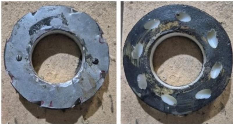
Figura 3.14 – Proteção metálica do swirler.
