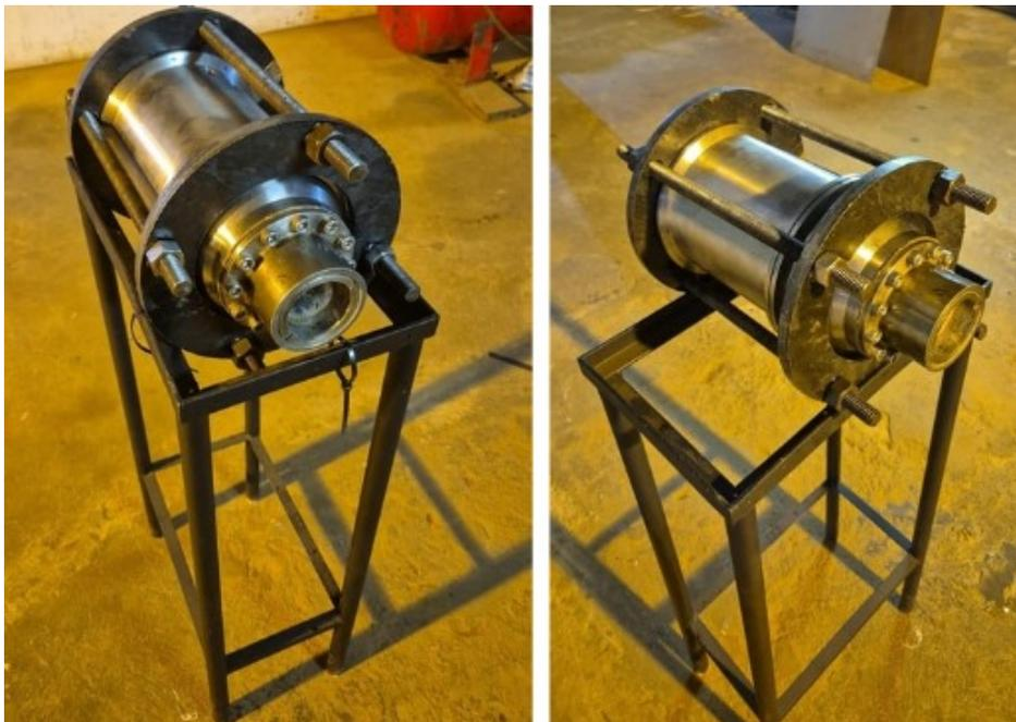
Figura 3.1 – Protótipo do motor SARA apoiado em estrutura de metal na posição horizontal.
