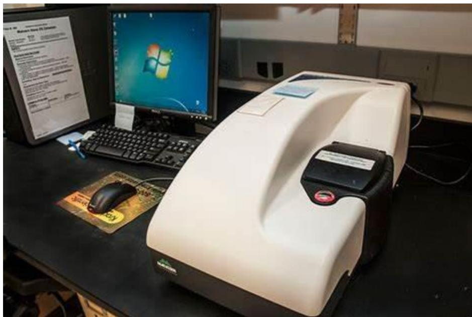
Figura 20: Equipamento Zetasizer Nano Series (*Malvern Instruments, Malvern, Inglaterra*) do laboratório da Faculdade de Ciências da Saúde da UnB.
