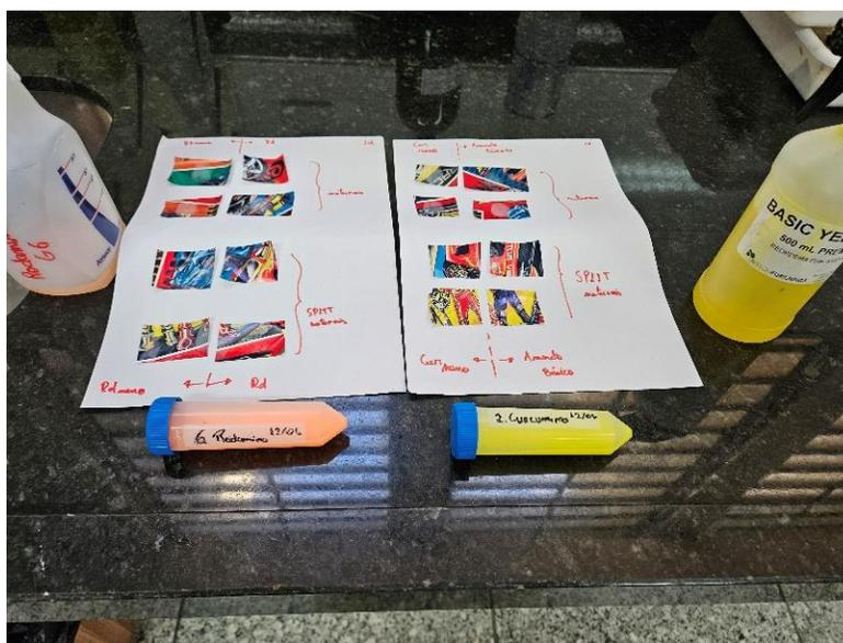
Figura 22: Arranjo experimental para a avaliação de soluções fluorescentes (Rodamina 6G, Amarelo Básico e Curcumina) aplicadas em superfícies polimerizadas com ECA.
