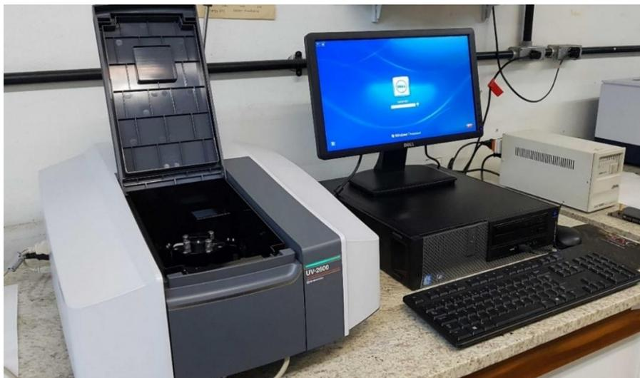
Figura 15: Espectrofotômetro UV-Vis Shimadzu UV-2600 do laboratório de Espectroscopia Óptica do Instituto de Física da UnB.
