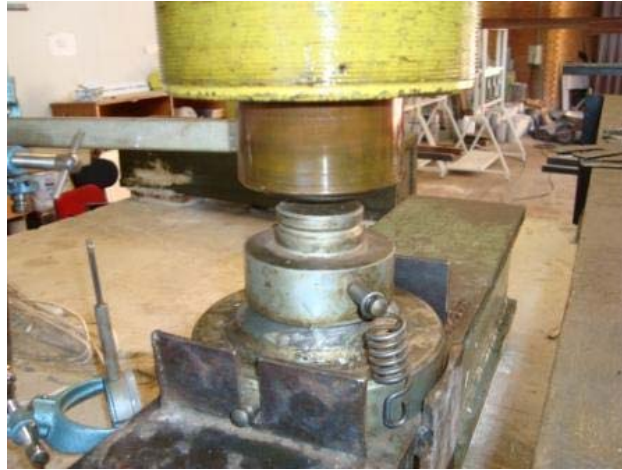
Figura 3.38 – Rótula para aplicação da carga P2.
