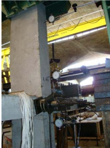
(g) – Defletômetros posicionados no pilar.
