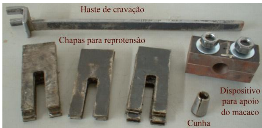
Figura 3.39 – Equipamentos empregados na etapa de protensão. – apud Villaverde (2003)
