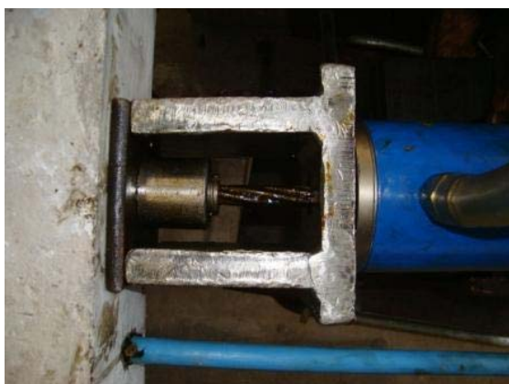
(a) – Barrilete e célula de carga durante processo de protensão.
