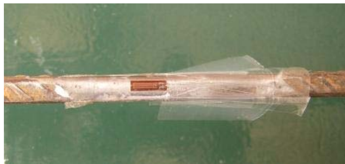
Figura 3.21 – Extensômetro colado em barra da armadura passiva.
