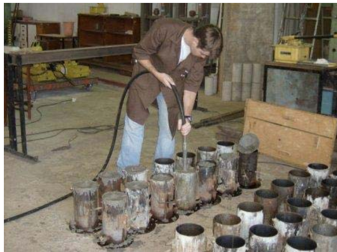
Figura 3.17 – Moldagem dos corpos de prova.
