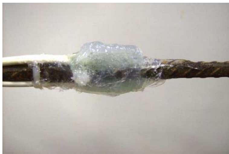
Figura 3.24 – Proteção mecânica dos extensômetros com silicone.
