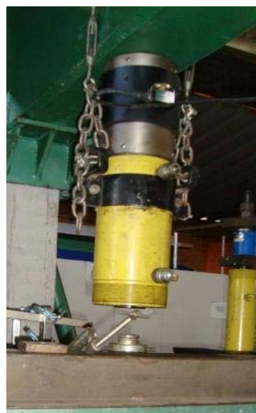
(b) – Macaco de aplicação da carga P2.
