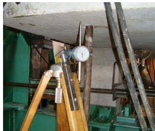
(f) – Defletômetros posicionados na face inferior.
