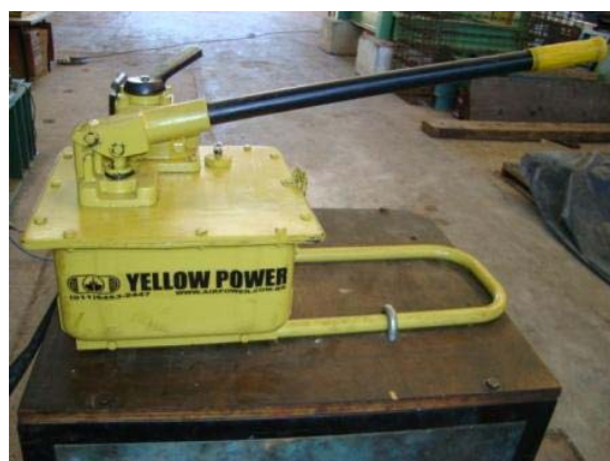
(d) – Bomba de aplicação da carga P2.
