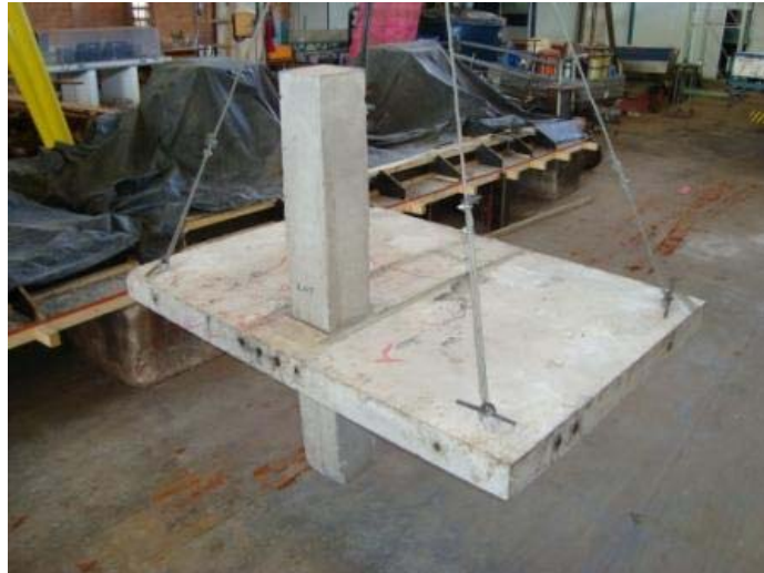
Figura 3.19 – Içamento e transporte dos modelos por meio de cabos de aço fixados em ganchos.
