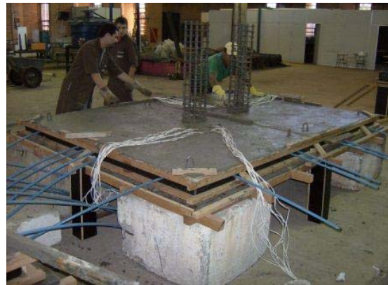
(b) – Acabamento da superfície do concreto.
