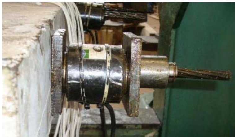
Figura 3.28 – Célula de carga empregada na ancoragem passiva.
