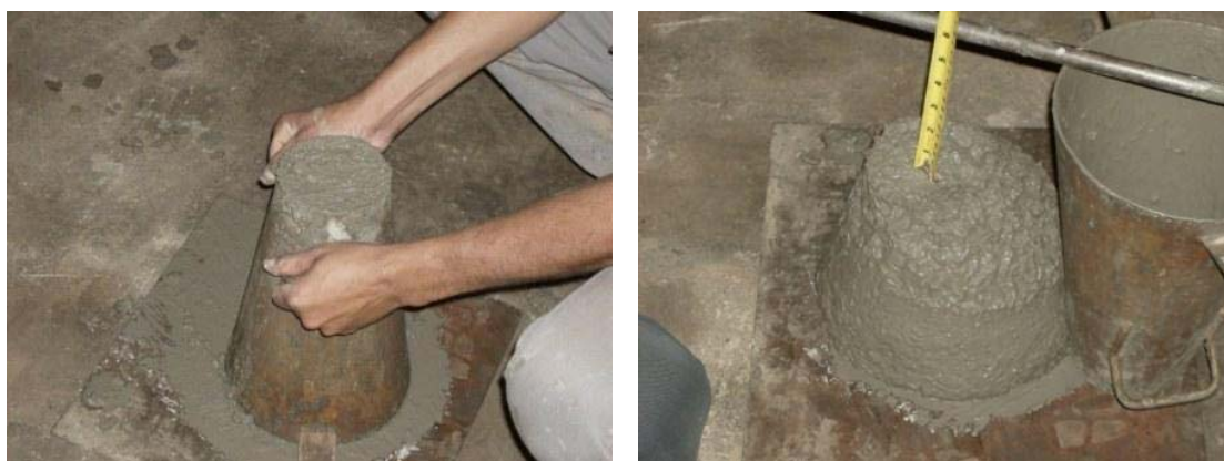
Figura 3.15 – Teste do abatimento do tronco de cone.
