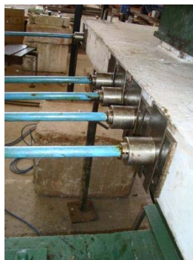
(b) – Detalhe da ancoragem ativa.
