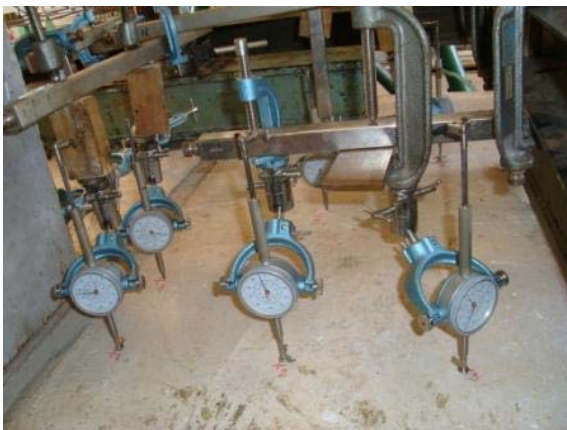
(e) – Defletômetros posicionados na face superior.
