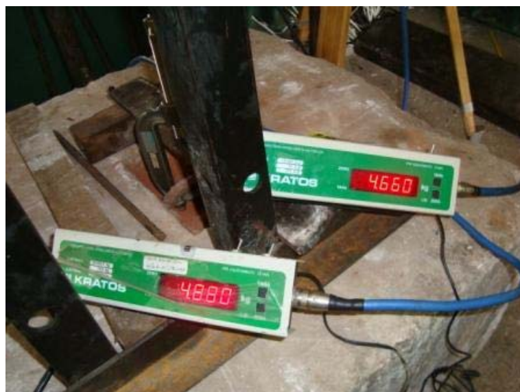
Figura 3.30 – Indicadores para acompanhamento dos passos de carga durante ensaio.
