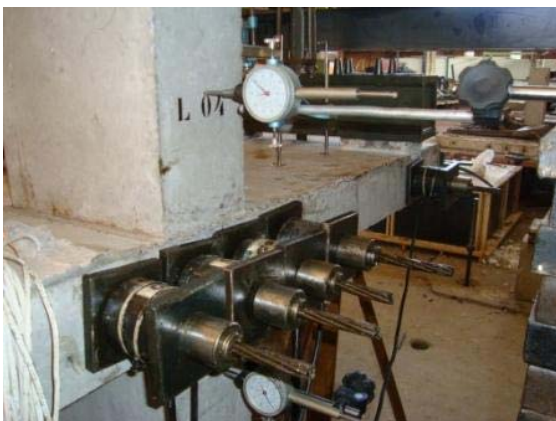
(a) – Detalhe da ancoragem passiva.
