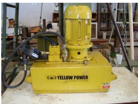
(c) – Bomba de aplicação das cargas P1.
