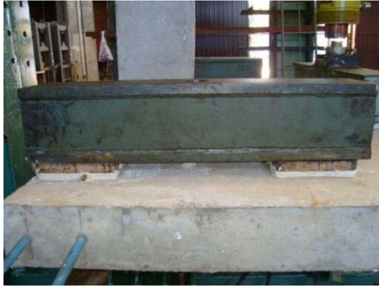
Figura 3.37 – Viga de distribuição da carga P1.
