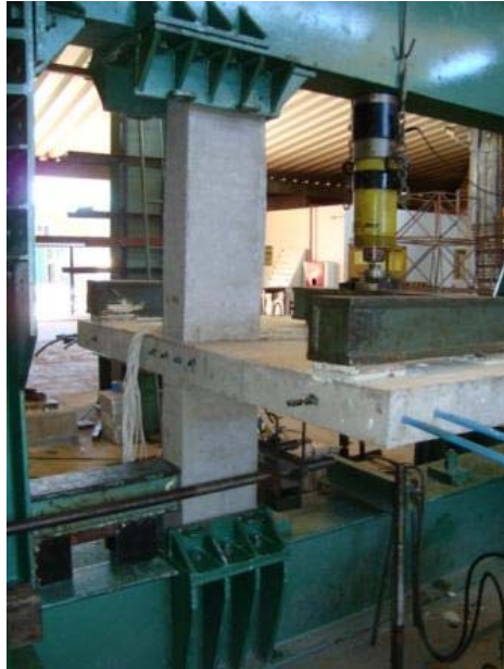
Figura 3.33 – Restrições metálicas nas extremidades do pilar.
