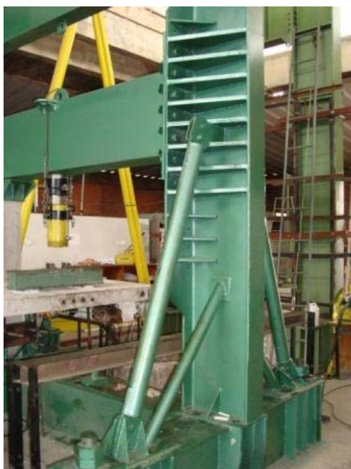
Figura 3.31 – Pórtico após a execução do reforço.
