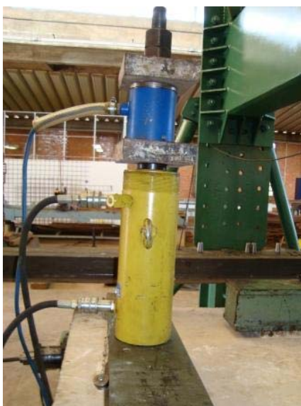
(a) – Macacos de aplicação da carga P1.
