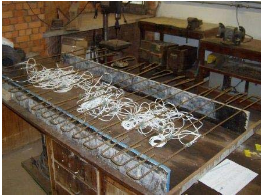
(a) – Bancada para colocação da proteção isolante com resina epóxi.
