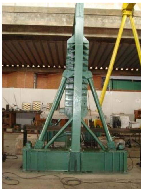
Figura 3.31 – Pórtico após a execução do reforço.
