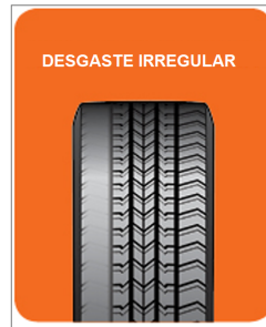
Figura 3.29: Desgaste irregular consequente de ângulo de Camber negativo. (WHAT..., 2023)
