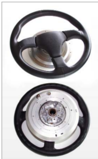
Figura 4.30: Equipamento para medição de ângulo e velocidade angular no volante
