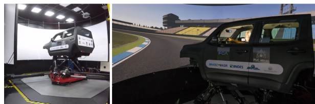
Figura 1.2: Simulador de dinâmica veicular para análises subjetivas com Driver in the Loop (DIL), situado em Belo Horizonte. Ferramenta utilizada neste trabalho para análises sensoriais ainda na fase de projetos.
