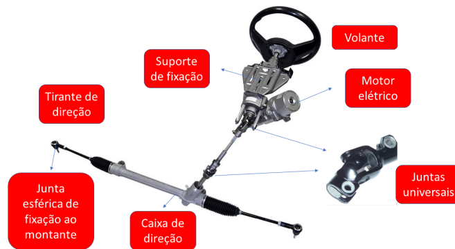
Figura 4.9: Coluna de direção completa, partes representadas no modelo multiplos corpos.
