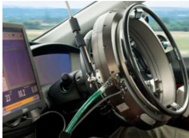
Figura 4.33: Robô acoplado a direção para acionamento do volante. (abdynamics, )
