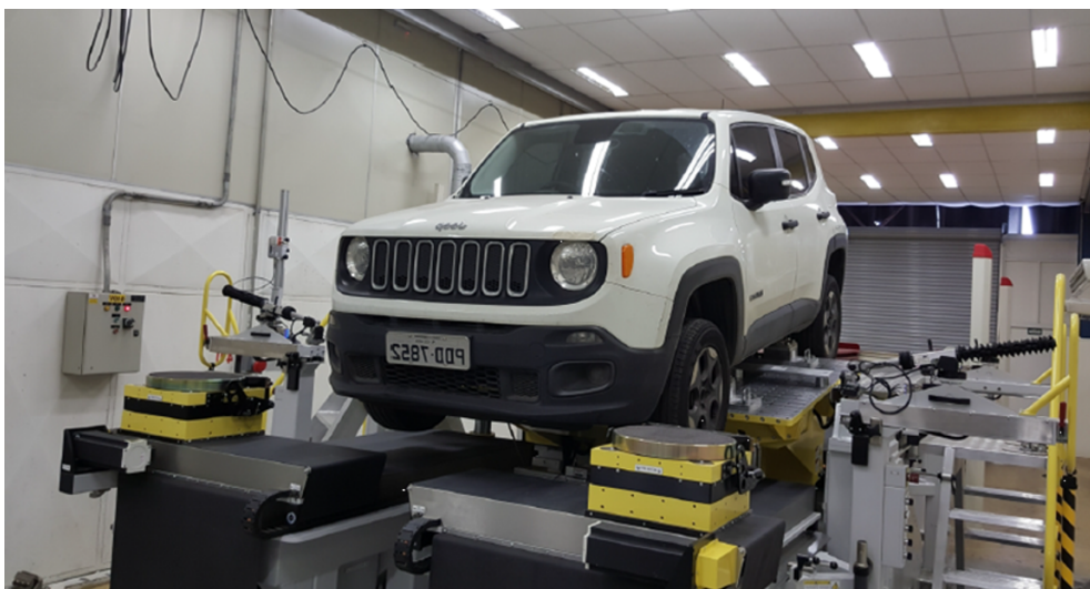
Figura 4.13: Banco de testes para levantamento das características elastocinemáticas de suspensões
