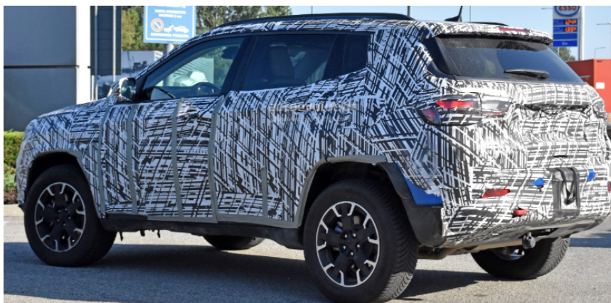
Figura 5.128: Mula - protótipo construído utilizando-se veículos pré existentes. (PANAIT, 2020)
