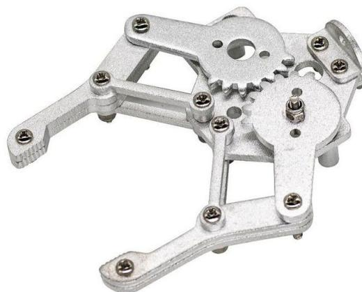
Figura 10 – Garra robótica de alumínio (SARAVATI, 2024).
