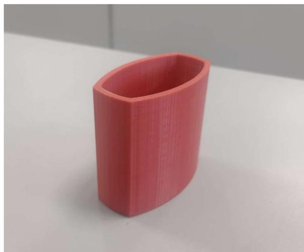
Figura 24 – Corpo de prova para experimentos na garra robótica.
