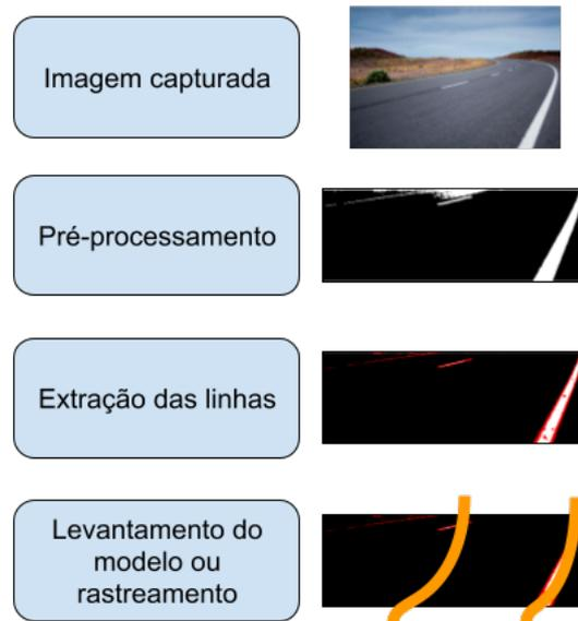
Figura 1 – Processamento de imagem na função LKAS
