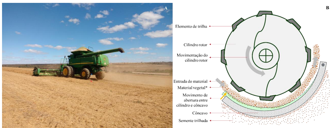
Figura 2. Colhedora de fluxo axial (John Deere® 9770 STS) no campo de produção de sementes de grão-de-bico (A) e mecanismo de trilha dessa colhedora (B).
