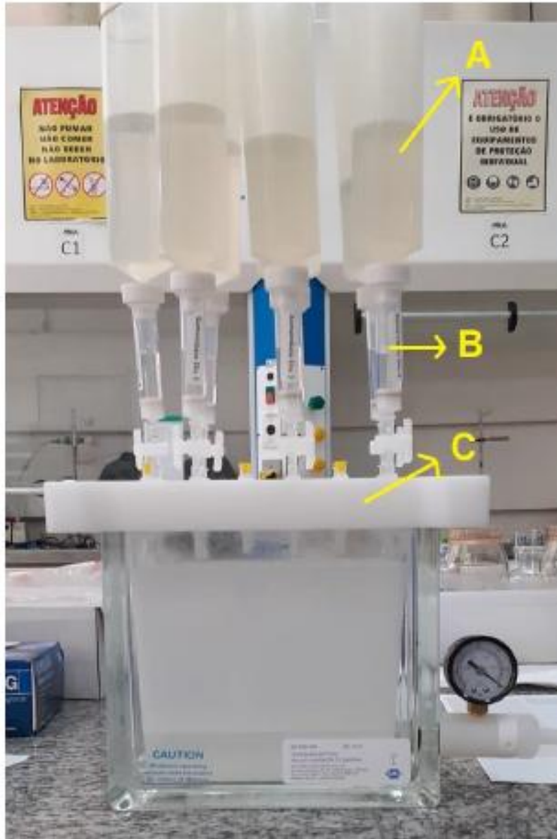
Figura 12 - Sistema de extração em fase sólida. A: recipiente contendo a amostra. B: cartucho de SPE. C: sistema manifold.
