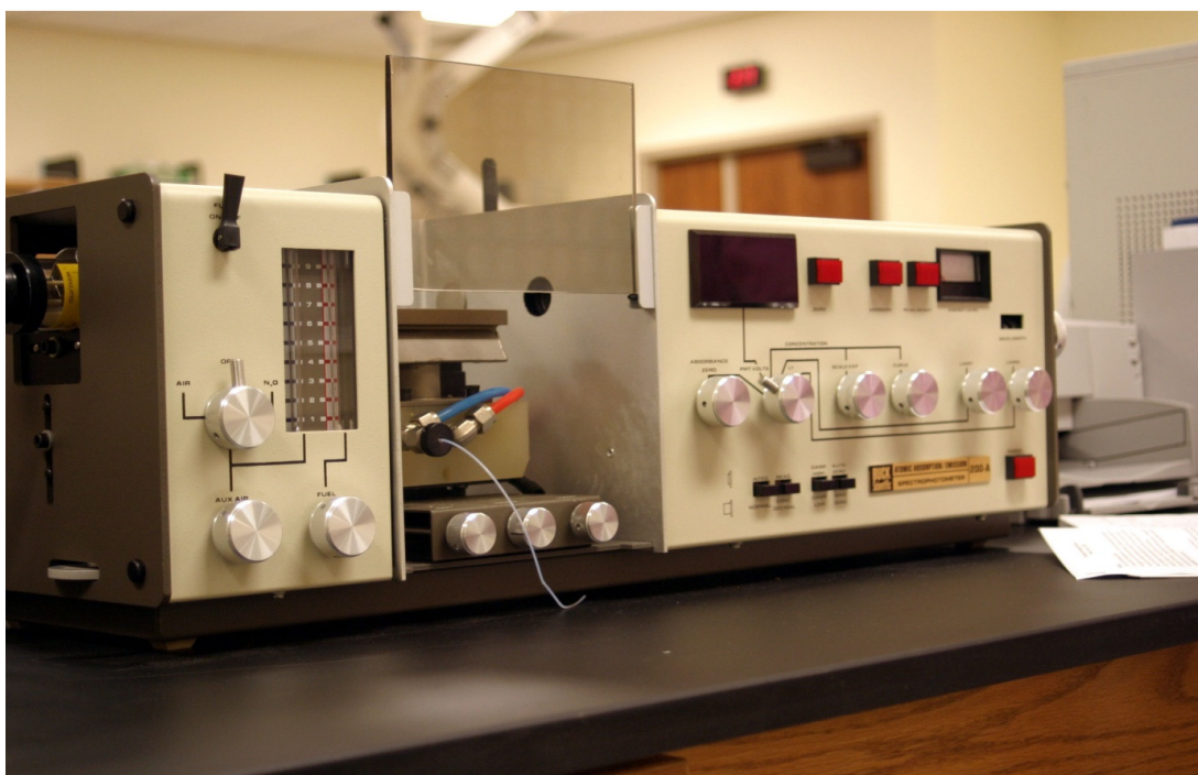
Figura 2.10 – Espectrômetro de Absorção Atômica, Buck Scientific 200A † .
