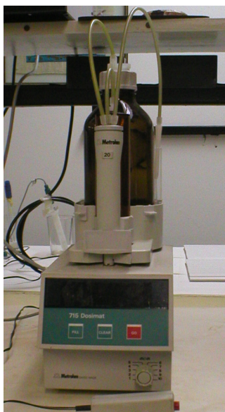
Figura 3.7 – Bureta eletrônica empregada no processo de titulação.
