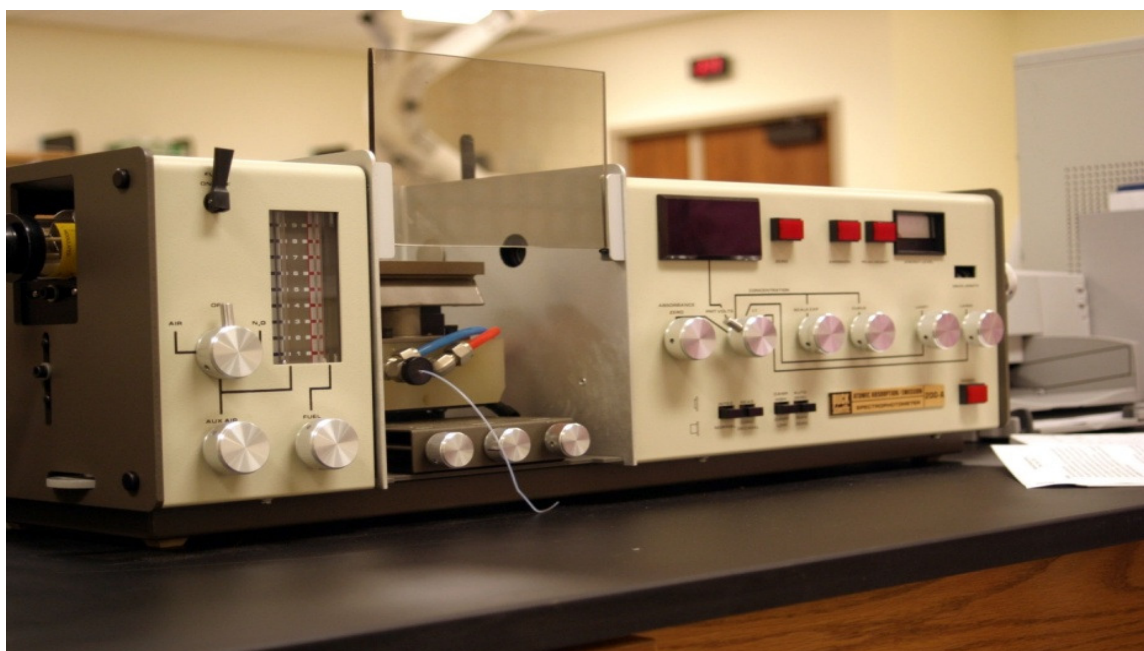
Figura 2.10 – Espectrômetro de Absorção Atômica, Buck Scientific 200A
