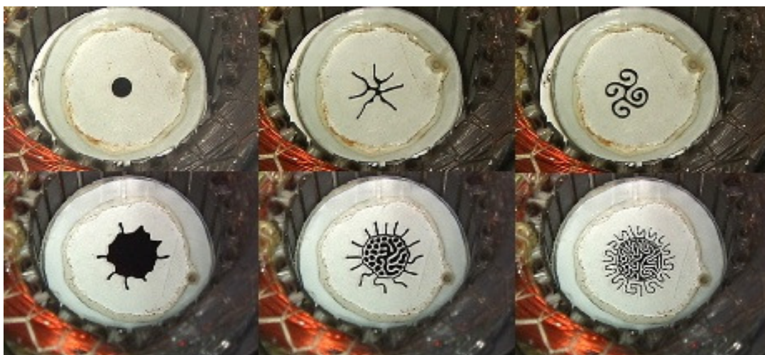
Figura 1.2 – Padrões em forma de labirinto, retirados da referência 2, formados por uma gota de fluido magnético confinada em célula de Hele-Shaw em presença de campo perpendicular.
