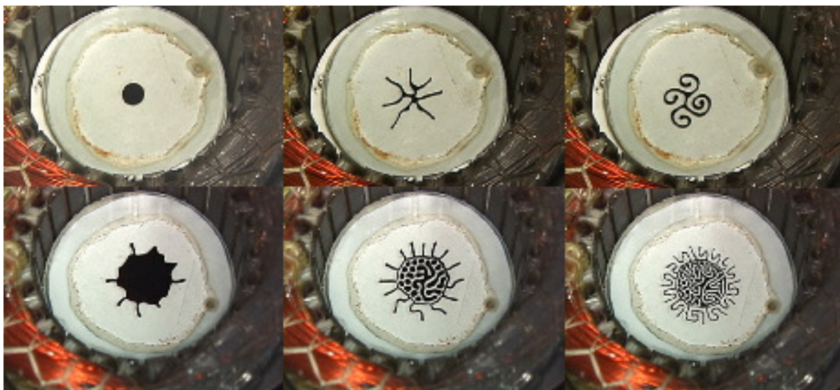
Figura 1.2 – Padrões em forma de labirinto, retirados da referência 2, formados por uma gota de fluido magnético confinada em célula de Hele-Shaw em presença de campo perpendicular.
