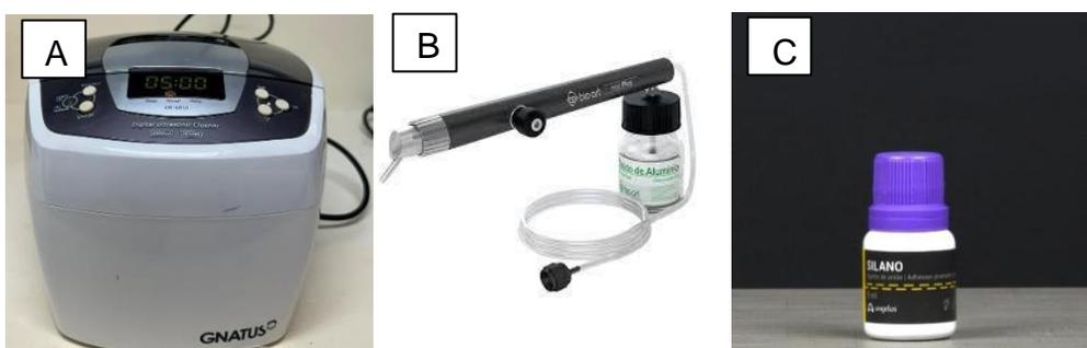
**Figura 4:** (A) cuba ultrassônica; (B) micro jato de óxido de alumínio; (C) silano.
