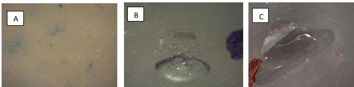
**Figura 10:** Padrão de falhas em aproximação 1,6x (A) fratura adesiva; (B) fratura mista; (C) fratura coesiva da base do corpo de prova (resina impressa)
