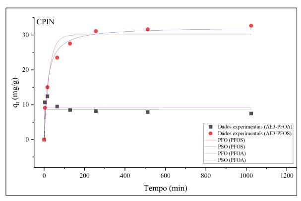
Figura 5.12: Dados cinéticos experimentais ajustados aos modelos de pseudo-primeira ordem (PFO) e pseudo-segunda ordem (PSO) para AE3 (PFOA+PFOS) com carvão ativado CPIN (C<sub>0</sub>=400μg PFOA/L + 400μg PFOS/L; T=25°C; pH 6,5).
