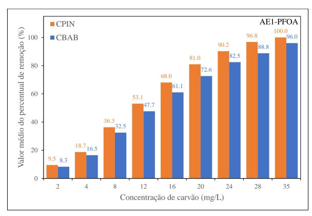
Figura 5.14: Percentual de remoção do PFOA em função da dosagem de carvão ativado (CBAB e CPIN) na AE1 (C<sub>0</sub>=600µg/L; T=25°C; pH 6,5; 512 minutos).
