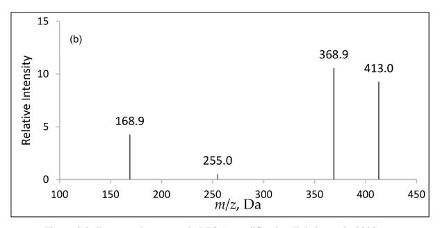
Figura 3.2: Espectro de massas do PFOA, modificado - Tahziz et al. (2020).
