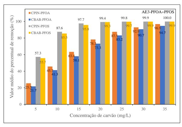
Figura 5.16 Percentual de remoção do PFOA e do PFOS em função da dosagem de carvão ativado (CBAB e CPIN) na AE3 (C<sub>0</sub>=400µg PFOA/L + 400µg PFOS/L; T=25°C; pH 6,5; 512 min).
