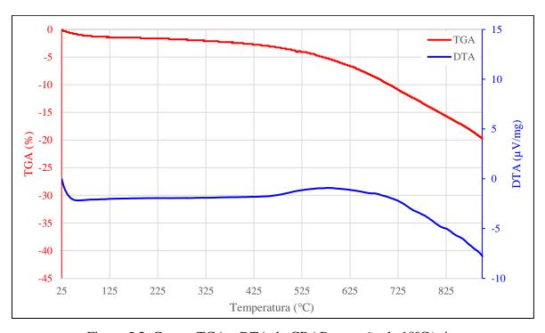
Figura 5.2: Curvas TGA e DTA do CBAB na razão de 10°C/min.
