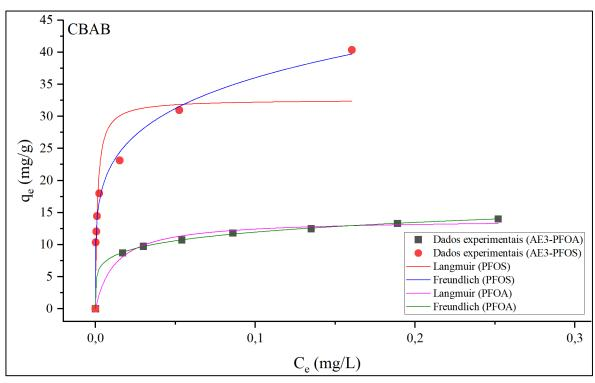
Figura 5.20: Isotermas de adsorção, modelos de Langmuir e de Freundlich, do PFOA e do PFOS no carvão CBAB para a AE3 (C<sub>0</sub>=400μg PFOA/L + 400μg PFOS/L; T=25°C; pH 6,5; 512 min).
