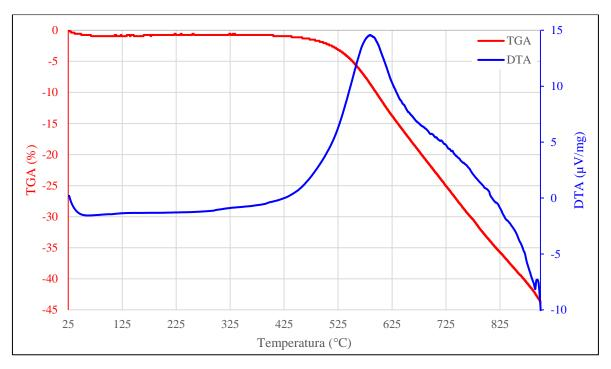
Figura 5.1: Curvas TGA e DTA do CPIN na razão de 10°C/min.
