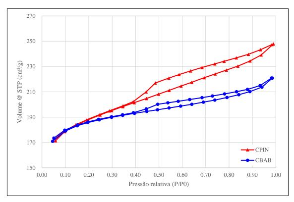
Figura 5.4: Isoterma de adsorção/dessorção de nitrogênio para o CPIN e CBAB.
