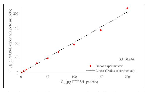
Figura 5.6: Faixa de trabalho de concentrações média e alta e linearidade para o método analítico de quantificação do PFOS.
