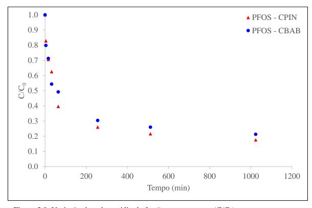
Figura 5.8: Variação do valor médio da fração remanescente (C/C<sub>0</sub>) com o tempo para o PFOS na AE2 (C<sub>0</sub>= $600\mu g/L$ ; T=25°C; pH 6,5).
