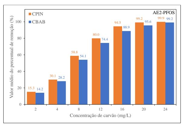
Figura 5.15: Percentual de remoção do PFOS em função da dosagem de carvão ativado (CBAB e CPIN) na AE2 (C<sub>0</sub>=600µg/L; T=25°C; pH 6,5; 512 minutos).
