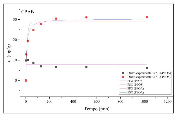
Figura 5.13: Dados cinéticos experimentais ajustados aos modelos de pseudo-primeira ordem (PFO) e pseudo-segunda ordem (PSO) para AE3 (PFOA+PFOS) com carvão ativado CBAB ( $C_0$ =400 $\mu$ g PFOA/L + 400 $\mu$ g PFOS/L; T=25°C; pH 6,5).
