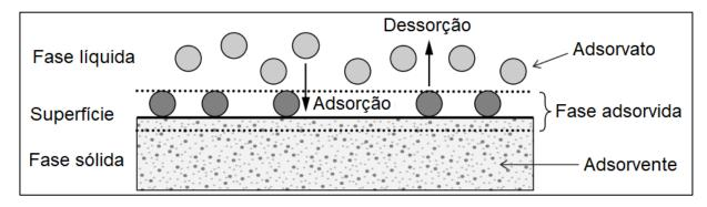
Figura 3.4: Termos básicos da adsorção, modificado - Worch (2012).
