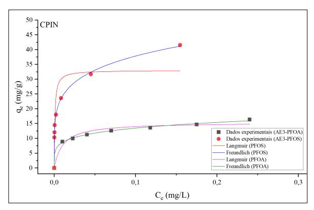
Figura 5.19: Isotermas de adsorção, modelos de Langmuir e de Freundlich, do PFOA e do PFOS no carvão CPIN para a AE3 (C<sub>0</sub>=400µg PFOA/L + 400µg PFOS/L; T=25°C; pH 6,5; 512 min).
