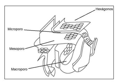
Figura 3.6: Estrutura esquemática de um carvão ativado, modificado - Moseley *et al.* (2018).
