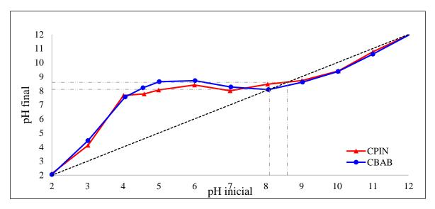
Figura 5.3: Gráfico do ensaio para levantamento do pH do ponto de carga zero (pH<sub>PCZ</sub>).
