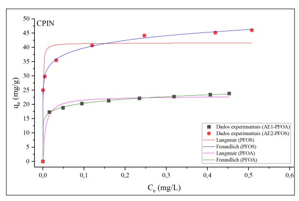
Figura 5.17: Isotermas de adsorção, modelos de Langmuir e de Freundlich, do PFOA e do PFOS no carvão CPIN para a AE1 e a AE2 (C<sub>0</sub>=600μg/L; T=25°C; pH 6,5; 512 minutos).
