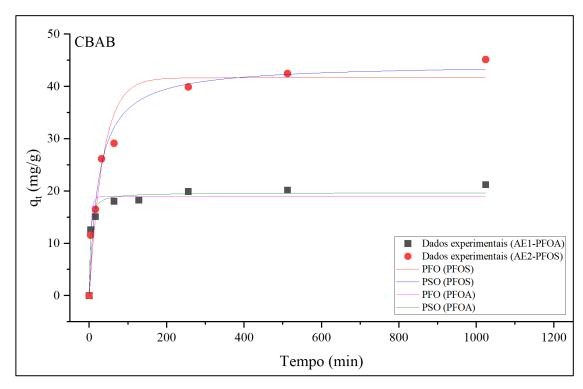
Figura 5.11: Dados cinéticos experimentais ajustados aos modelos de pseudo-primeira ordem (PFO) e pseudo-segunda ordem (PSO) para AE1 (PFOA) e AE2 (PFOS) com carvão ativado CBAB (C<sub>0</sub>=600μg/L; T=25°C; pH 6,5).
