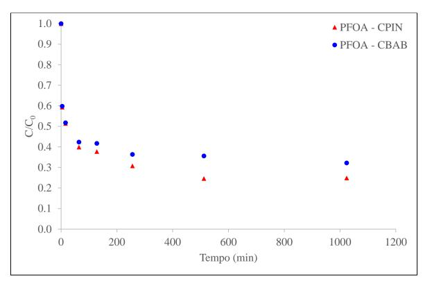
Figura 5.7: Variação do valor médio da fração remanescente ( $C/C_0$ ) com o tempo para o PFOA na AE1 ( $C_0$ =600 $\mu$ g/L; T=25°C; pH 6,5).
