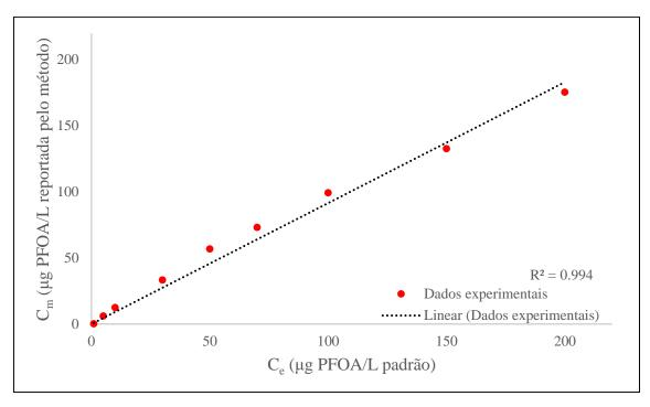
Figura 5.5: Faixa de trabalho e linearidade para o método analítico de quantificação do PFOA.
