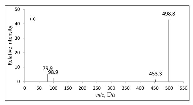
Figura 3.3: Espectro de massas do PFOS, modificado - Tahziz et al. (2020).
