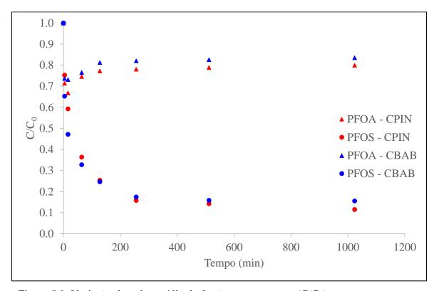
Figura 5.9: Variação do valor médio da fração remanescente ( $C/C_0$ ) com o tempo para o PFOA e o PFOS na AE3 ( $C_0$ =400 $\mu$ g PFOA/L + 400 $\mu$ g PFOS/L; T=25°C; pH 6,5).
