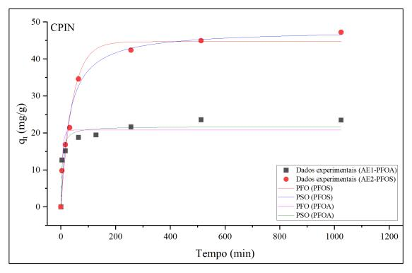
Figura 5.10: Dados cinéticos experimentais ajustados aos modelos de pseudo-primeira ordem (PFO) e pseudo-segunda ordem (PSO) para AE1 (PFOA) e AE2 (PFOS) com carvão ativado CPIN (C<sub>0</sub>=600μg/L; T=25°C; pH 6,5).
