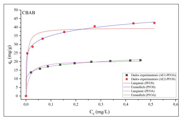
Figura 5.18: Isotermas de adsorção, modelos de Langmuir e de Freundlich, do PFOA e do PFOS no carvão CBAB para a AE1 e a AE2 (C<sub>0</sub>=600μg/L; T=25°C; pH 6,5; 512 minutos).
