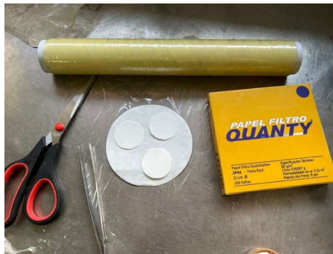
Figura 4.16. Materiais utilizados no ensaio de papel filtro.
