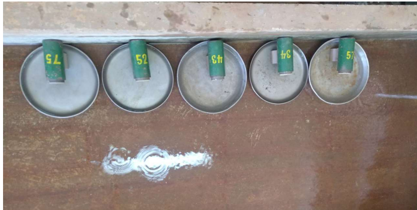
Figura 4.11. Amostras compactadas em cilindro Mini-MCV submetidas à perda de massa por imersão em tanque com água.
