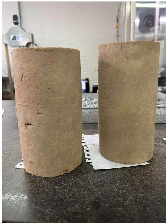
Figura 5.121. SL-3 – CP compactado na umidade +2%wot após o ensaio de DP, na sequência 3 (à esquerda) e CP compactado na umidade +2%wot antes do ensaio (à direita).
