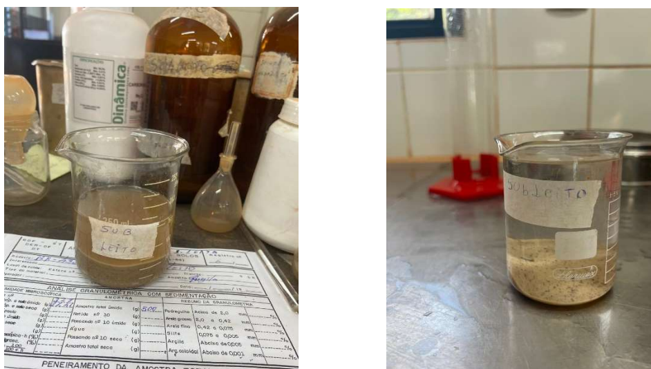
Figura 4.10. Amostras com (à esquerda) e sem defloculante (à direita), empregado no ensaio de sedimentação.
