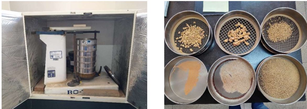
Figura 4.9. Agitador mecânico empregado no peneiramento das amostras de solos e material britado – à esquerda. Peneiras de diferentes aberturas com amostras de solo – à direita.
