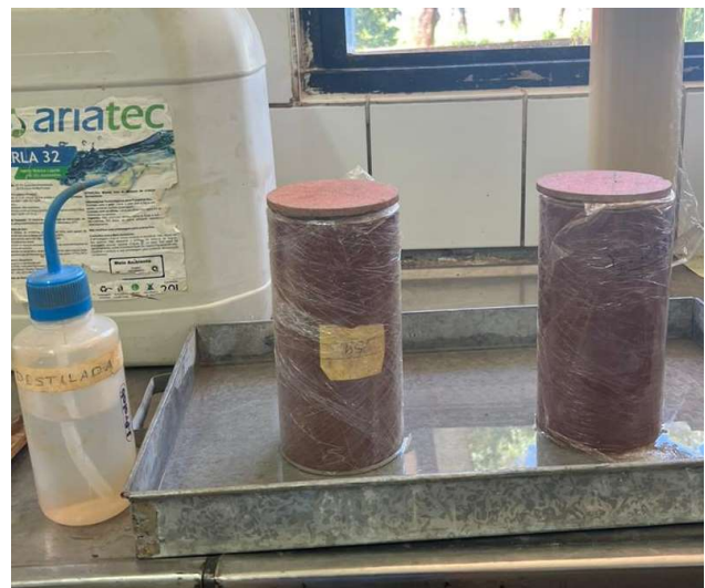
Figura 4.15. CP com variação de umidade pós-compactação – umedecimento por capilaridade.
