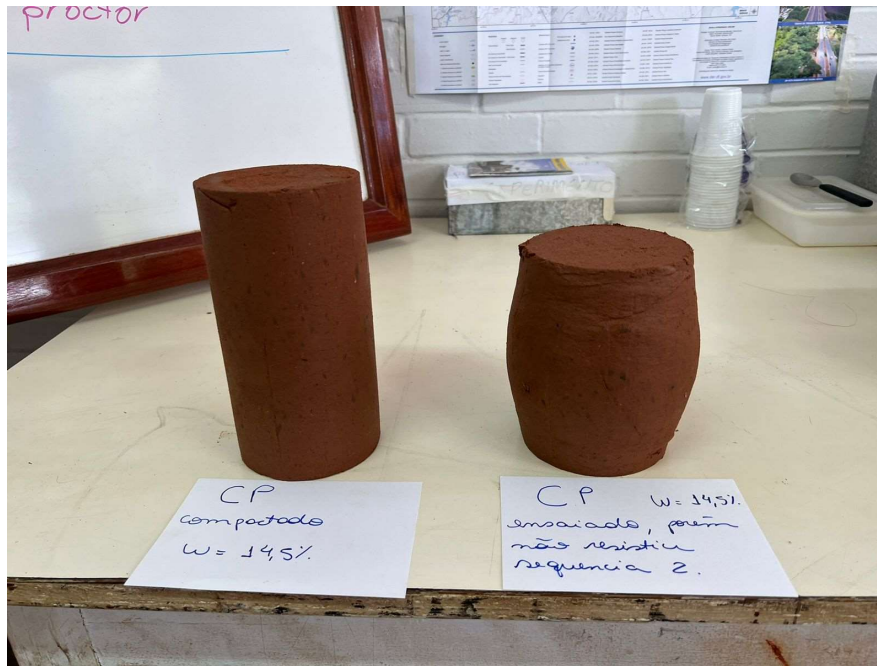
Figura 5.116. SL-2 – CP compactado na umidade +2%wot (à esquerda) na sequência 2; CP compactado na umidade +2%wot após o ensaio de DP na sequência 2 (à direita).
