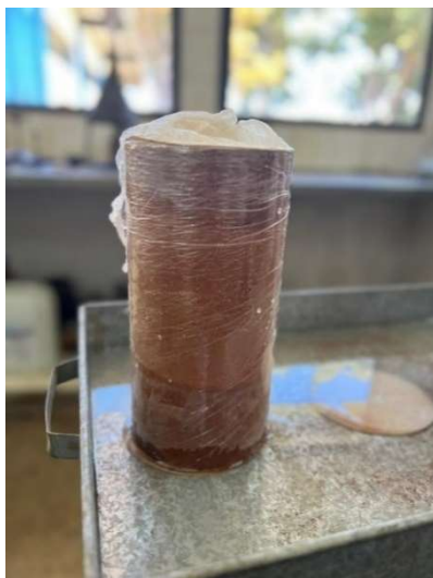
Figura 4.15. CP com variação de umidade pós-compactação – umedecimento por capilaridade.
