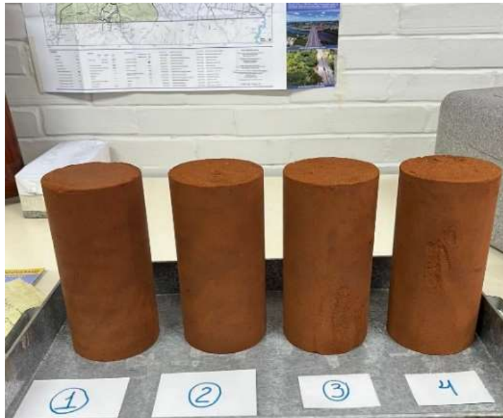
Figura 4.14. CP com variação de umidade pós-compactação – secagem ao ar.
