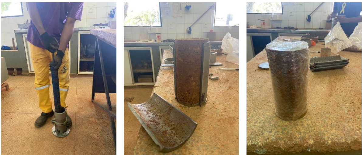
Figura 4.12. Procedimento compactação de amostras no cilindro tripartido.
