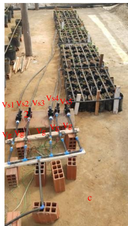
Figura 8 – Temporizador eletrônico digital utilizado no acionamento do sistema de irrigação no E1 (a), válvulas solenoides (Vs1 a Vs5) acionadas por um painel semiautomatizado, válvula de gaveta (Vg) no E2 (c), interface para identificação das válvulas solenoides (d) e status, data e hora de acionamento das válvulas solenoides e seus respectivos tempos de irrigação, em segundos para cada evento de irrigação (e).
