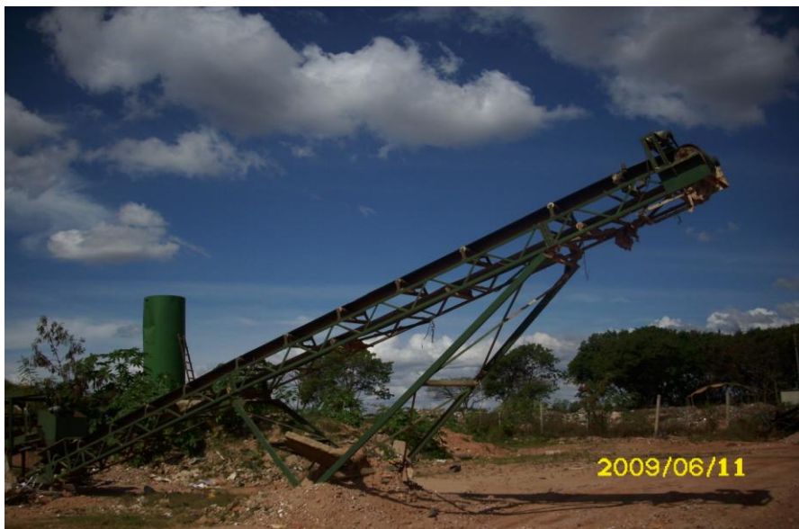
Foto 1: Separador de Resíduos da Construção e Demolição de Classe A da mini-usina de beneficiamento de RCDs no Aterro Controlado, “lixão”.
