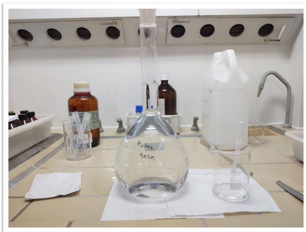
Figura 24 - Solução fraca de Ácido Sulfúrico (0,05 M de H_2SO_4 ).
