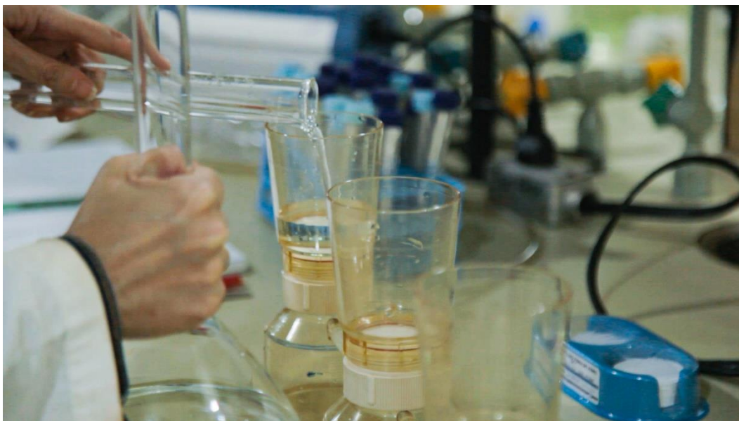
Figura 19 - Processo de Filtração das Amostras.
