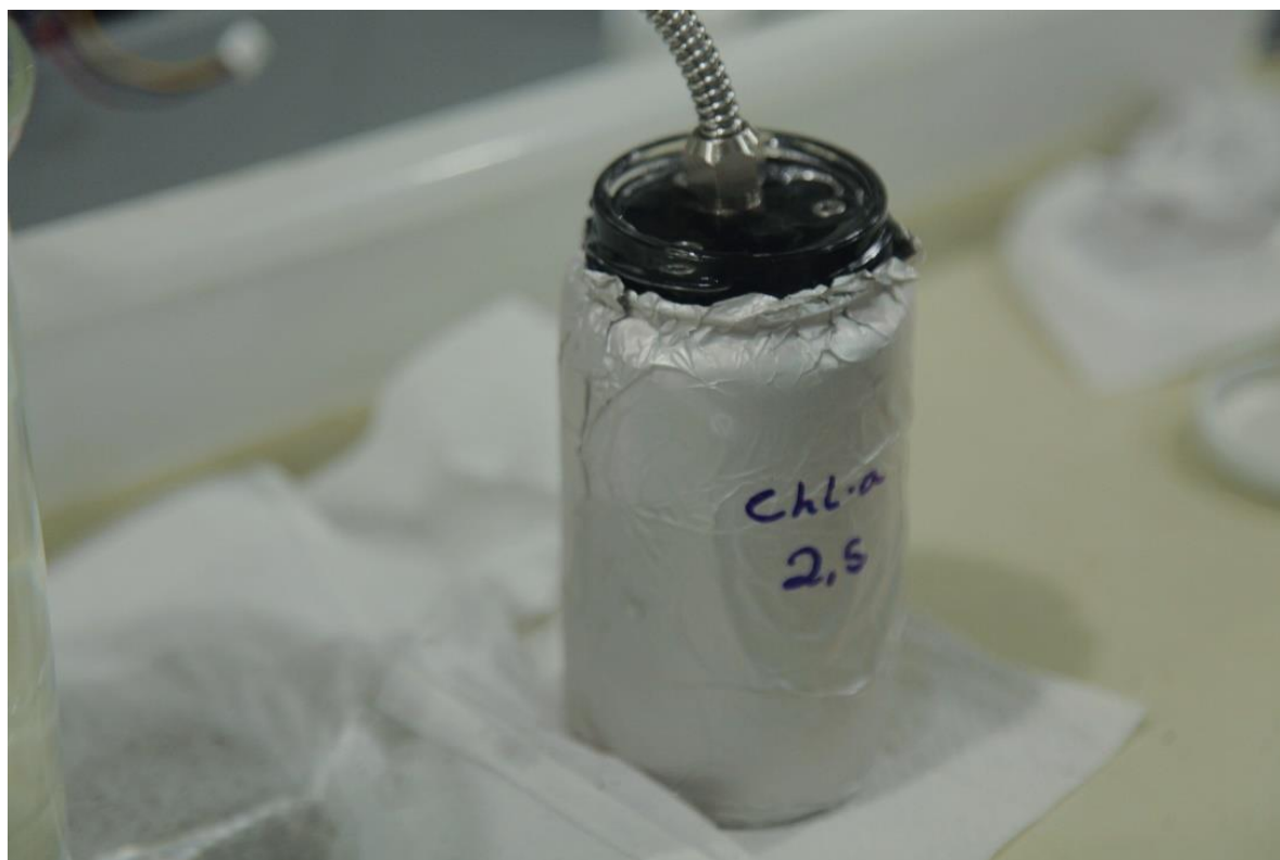
Figura 18 - Realização da Leitura via Sonda MPMS em Frasco de Vidro.
