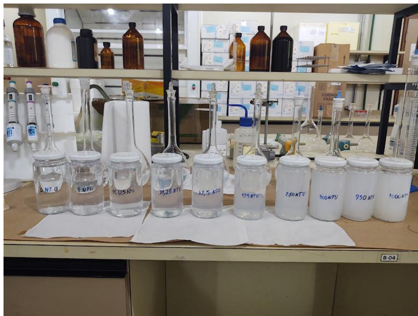
Figura 26 – Frascos de vidro com em diferentes concentrações de turbidez.
