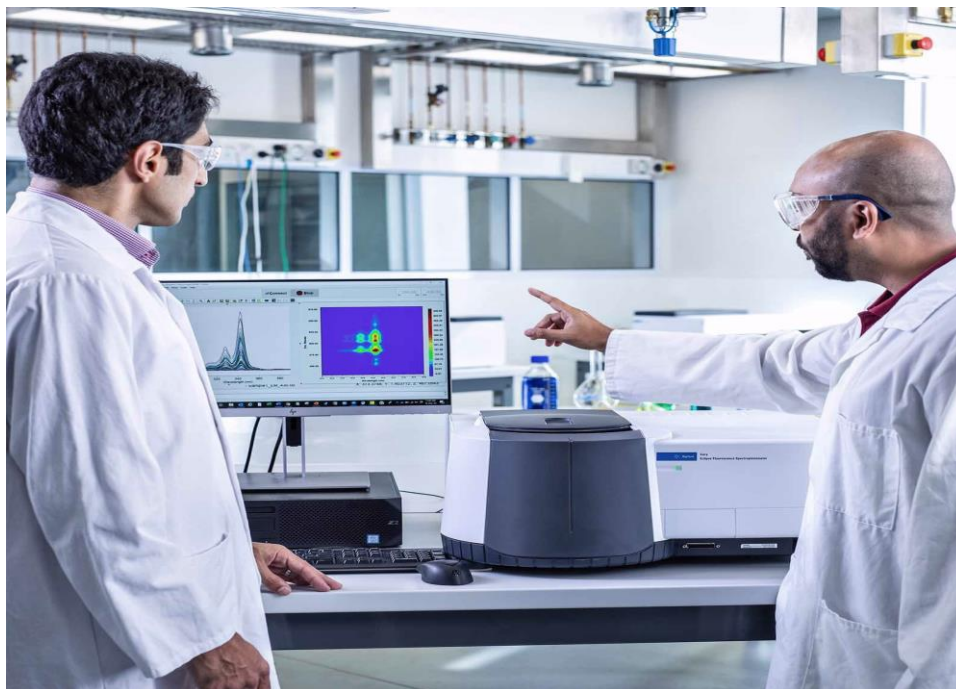
Figura 32 – Fluorímetro Cary Eclipse da Agilent Technologies conectado ao software Cary WinFLR.
