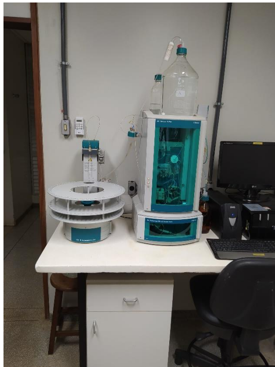
Figura 23: Cromatógrafo de íons compacto 930 IC Flex do IB
