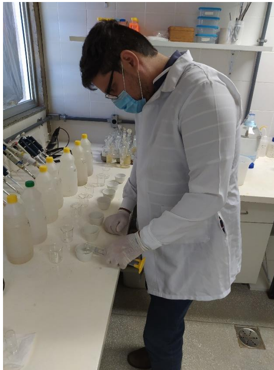
Figura 24: Preparação das amostras para análise de sólidos dissolvidos.
