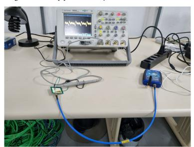
Figura 66 – Setup para as medições utilizando a Pluto SDR.
