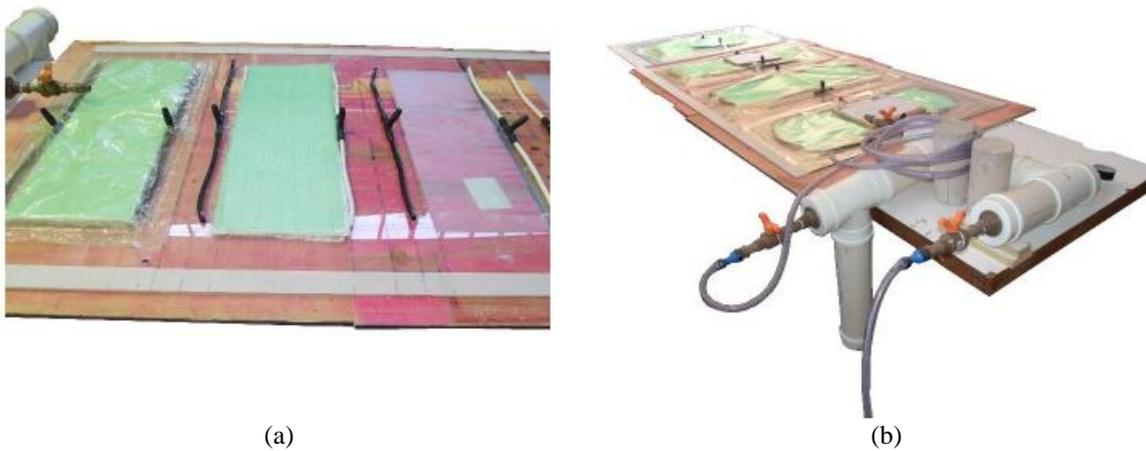
Figura 10 – Sistema de produção de compósitos de baixo custo por meio de infusão de resina à vácuo: (a) materiais para infusão de resina à vácuo sobre bancada; (b) Sistema de infusão de resina à vácuo parcialmente pronto para uso. Adaptado de Silva (2020)
