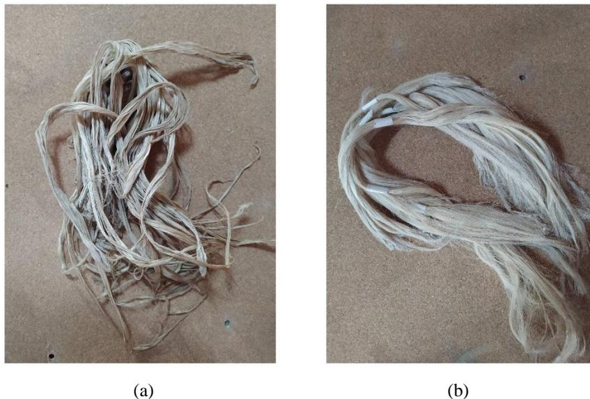
Figura 13 - a) fibras de curauá em seu estado natural conforme recebimento e b) desemaranhadas. Fonte: Autor (2023)
