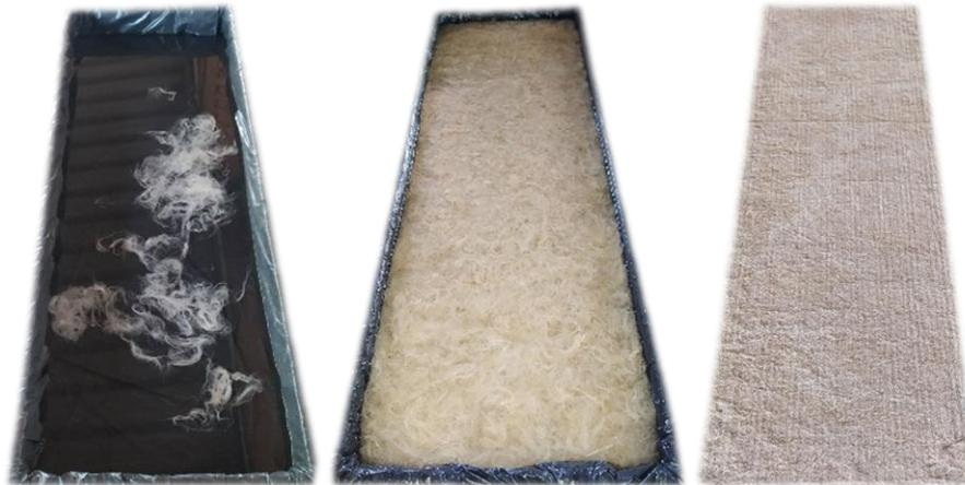
Figura 15 – Espalhamento de fibras em água destilada para fabricação das mantas de fibras de curauá. Fonte: Autor (2023)
