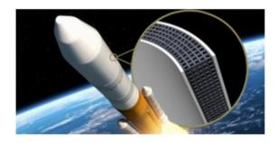
Figura 1.3: Metamateriais elásticos em uma aplicação de carenagem aeroespacial[Bergamin 2016]
