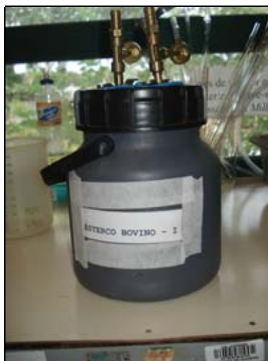
Figura 4.2: Recipiente utilizado como bioreator na pesquisa.
