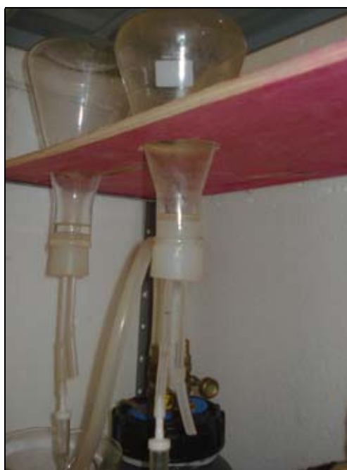
Figura 4.4: Frascos de Mariotte utilizado no experimento.
