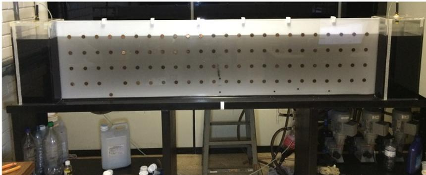
Figura 1.1: Célula de Hele-Shaw do Laboratório de Automação Offshore da Universidade de Brasília (Fortaleza et al., 2019)
