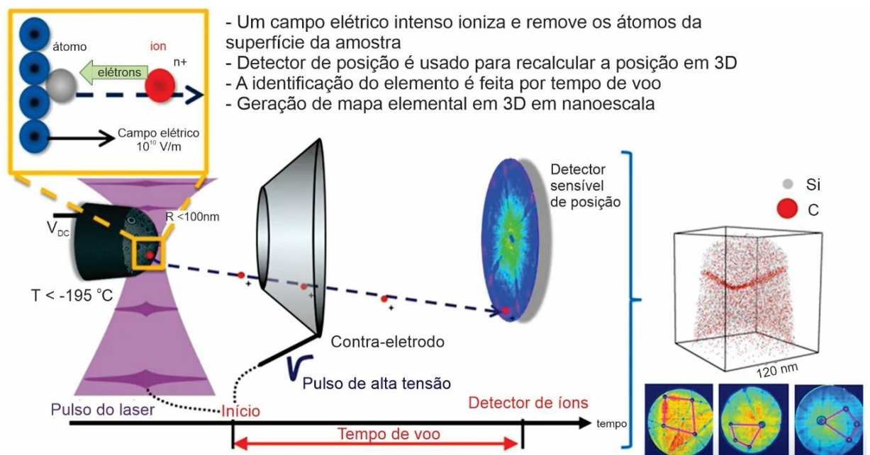
Fig. 2-2. Visão esquemática de um microscópio atômico (APT). O espécimen amostral é congelado ( T < -195 °C), submetido a um campo de alta tensão ( V_{DC} ) e iluminado por pulsos de laser, desencadeando a evaporação do campo de íons, que voam através de um contra eletródo e são coletados pelo detector sensível de posição. O detector também registra o tempo de voo, o que permite a identificação do elemento (Modificado e adaptado de Gault, 2016).
