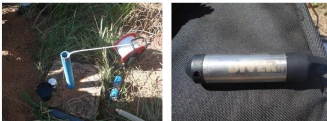
**Figura 2. 2.** Medidor de nível para medição manual do NF e transdutor de pressão (*diver*) para medições automáticas do NF.
