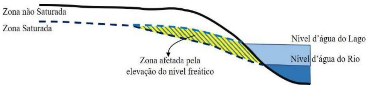
**Figura 3. 9.** Ilustração esquemática mostrando a elevação do nível freático Campos *et al.* (2019).
