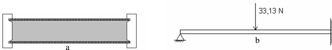
Figura 3.6 – (a) Tubo. (b) Diagrama de corpo livre.
