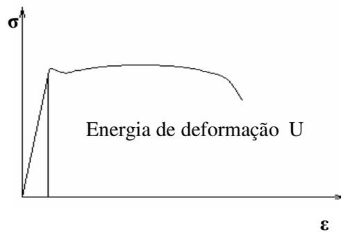
Figura 2.16 – Diagrama Tensão x Deformação  $\sigma$  x  $\epsilon$ , para materiais dúteis.
