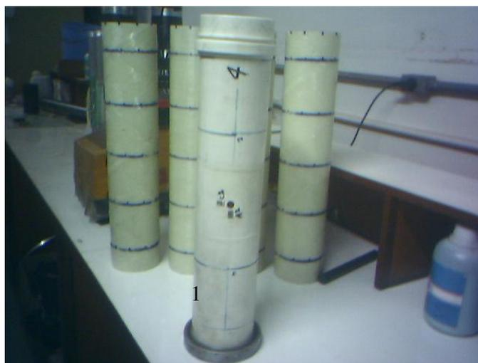
Figura 2.19 – Tubulação de P.V.C. (1) Antes do processo de bobinagem.
