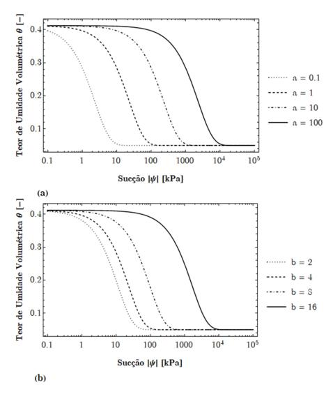
Figura 8.6 – Análise de sensibilidade do (a) parâmetro a ( $e=0,7;\ b=4;\ \theta_r=0,05$ ) e (b) parâmetro b ( $e=0,7;\ a=1;\ \theta_r=0,05$ ).
