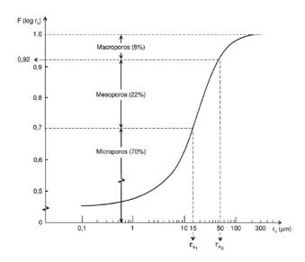
Figura 3.1 – Exemplo de curva da função frequência acumulada de raios (Libardi, 2010).
