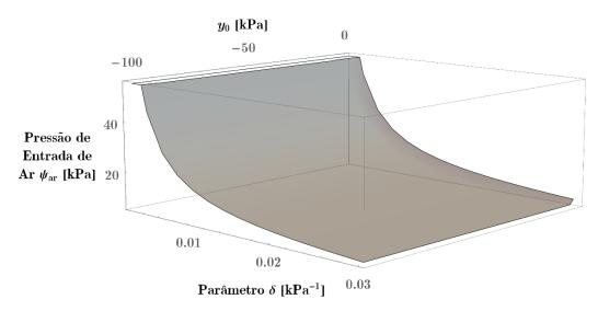
Figura 8.2 – Superfície que relaciona a pressão de entrada de ar com o parâmetro hidráulico  $\delta$  e o valor da abcissa  $y_0$  da curva de retenção ( $\theta_s=0,41;\,\theta_r=0,02$ ).
