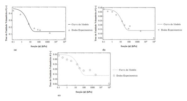
Figura 8.9 – Comparação entre a curva do modelo e os pontos experimentais de Quaglia (2018) para diferentes índices de vazios: (a) e = 0.901; (b) e = 0.623; (c) e = 0.539.
