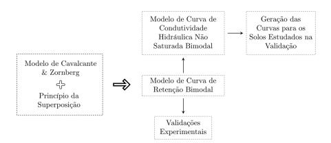
Figura 5.8 – Diagrama das etapas realizadas para obtenção e validação dos modelos constitutivos desenvolvidos para solos bimodais.
