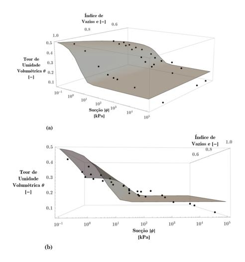
Figura 8.7 – Representação do modelo 3D de superfície de retenção para os dados de Quaglia (2018) em: (a) visão de canto e (b) visão lateral ( $a=0.78; b=2.95; \theta_r=0.14$ ).
