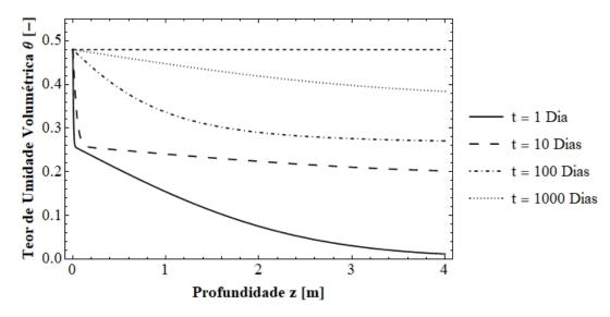
Figura 6.8 – Simulação do processo de infiltração no solo bimodal de El Volador a tempos fixos variando-se a profundidade ( $\lambda=0,46;~\delta_1=0,0220304~kPa^1;~\delta_2=0,000004~kPa^1;~k_s=4\times10^{-9}~m/s;~\theta_s=0,48;~\theta_r=0.0000047;~\psi_0=0~kPa,~\psi_i=-100.000~kPa,~L=10m$ ).
