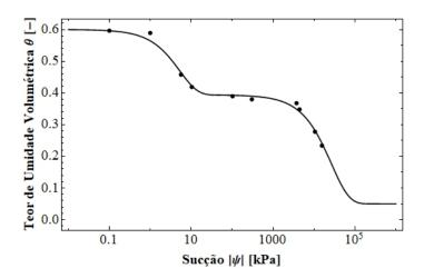
Figura 7.10 – Validação experimental do modelo bimodal de curva de retenção de água no solo utilizando os dados de Futai & Almeida (2005) ( $\lambda=0.37,\ \delta_1=0.19046\ \mathrm{kPa^{-1}},\ \delta_2=0.00004\ \mathrm{kPa^{-1}},\ \theta_s=0.60,\ \theta_r=0.05$ ).
