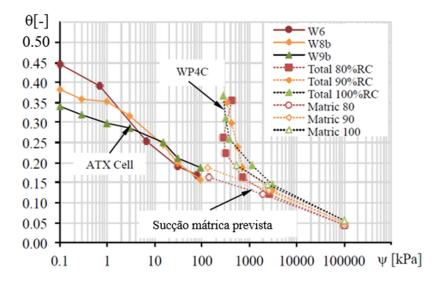
Figura 5.1 – Curvas de retenção para a argila de baixa plasticidade RMA a diferentes índices de vazio (modificado de Quaglia, 2018).
