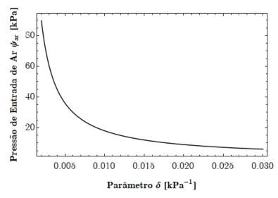
Figura 8.4 – Relação entre a pressão de entrada de ar  $(\psi_{ar})$  e o parâmetro hidráulico  $\delta$  considerando o ponto  $\psi_0$  próximo a zero.
