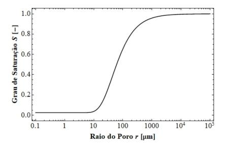
Figura 7.1 – Curva da função frequência acumulada de raios para um solo granular ( $\theta_s = 0.40, \; \theta_r = 0.01, \; \delta = 0.3 \; \text{kPa}^{-1}, \; \sigma = 0.07275 \cdot 10^{-3} \; \text{kN} \cdot \text{m}^{-1}$ ).
