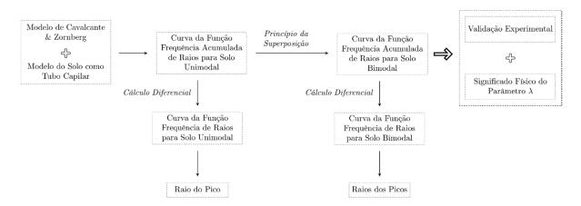
Figura 5.10 – Diagrama das etapas realizadas para a realização do desenvolvimento e da validação dos modelos de distribuição de poros.
