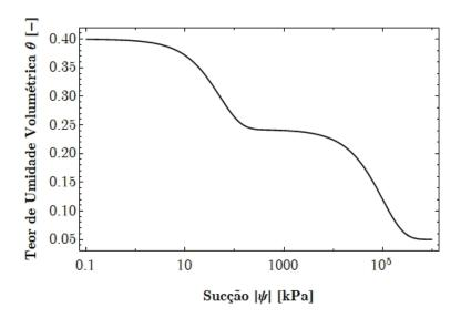
Figura 6.1 – Ilustração da curva de retenção de água no solo bimodal obtida a partir do modelo proposto ( $\lambda=0.45;\ \delta_1=0.02\ kPa^{-1};\ \delta_2=0.00001\ kPa^{-1};\ \theta_s=0.40,\ \theta_r=0.05$ ).
