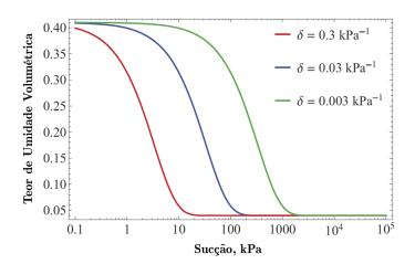
Figura 2.3 – Análise paramétrica do parâmetro hidráulico  $\delta$  na curva de retenção de água no solo ( $\theta_s=0.41,\,\theta_r=0.04,\,k_s=8,2\times10^{-7}~m/s$ ) (modificado de Cavalcante & Zornberg, 2017a).
