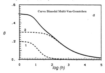
Figura 3.4 – Ilustração da curva bimodal do modelo Multi-Van-Genuchten proposta por Durner (1992).
