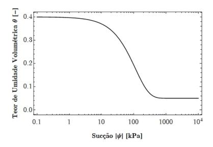
Figura 2.1 – Exemplo de curva de retenção de água no solo.
