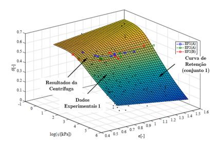
Figura 4.1 – Superfície de Retenção da argila *Eagle Ford* obtida usando diferentes metodologias experimentais (modificado de Quaglia, 2018).
