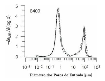
Figura 3.3 – Distribuição de poros obtida a partir do ensaio do porosímetro de mercúrio (Yuan et al., 2019).
