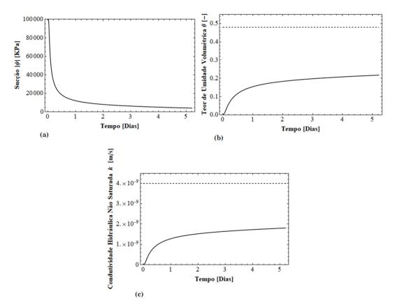
Figura 6.6 – Simulação do processo de infiltração no solo bimodal de El Volador após 5 dias em uma profundidade de 1 m ( $\lambda=0.46$ ;  $\delta_1=0.0220304~kPa^1$ ;  $\delta_2=0.000004~kPa^1$ ;  $k_s=4\times10^{-9}~m/s$ ;  $\theta_s=0.48$ ;  $\theta_r=0.0000047$ ;  $\psi_0=0~kPa$ ,  $\psi_i=-100.000~kPa$ , L=10m) expressando a relação entre: (a)  $|\psi|$  e tempo; (b)  $\theta$  e tempo e (c) k e tempo.
