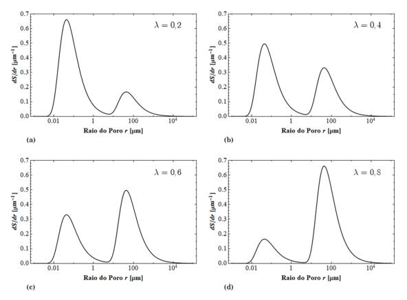
Figura 7.9 – Análise paramétrica de  $\lambda$  na curva da função frequência de raios ( $\theta_s$  = 0.40,  $\theta_r$  = 0.01,  $\delta_l$  = 0.3 kPa<sup>-1</sup>,  $\delta_2$  = 0.0003 kPa<sup>-1</sup>,  $\sigma$  = 0.07275·10<sup>-3</sup> kN·m<sup>-1</sup>).
