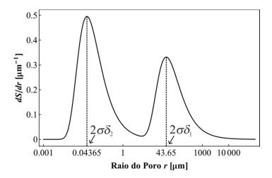
Figura 7.7 – Curva da função frequência de raios de um solo bimodal com os raios dos picos calculados utilizando a Eq. (7.11) ( $\theta_s = 0.40$ ,  $\theta_r = 0.01$ ,  $\delta_l = 0.3$  kPa<sup>-1</sup>,  $\delta_l = 0.0003$  kPa<sup>-1</sup>,  $\lambda = 0.40$ ,  $\sigma = 0.07275 \cdot 10^{-3}$  kN·m<sup>-1</sup>).
