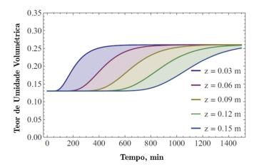
Figura 2.4 – Evolução do teor de umidade volumétrica a diferentes profundidades ( $\delta=0.03~kPa^{-1};~\theta_s=0.41,~\theta_r=0.04,~k_s=8.2\times10^{-7}~m/s$ ) (modificado de Cavalcante & Zornberg, 2017a).
