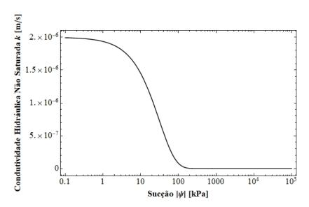
Figura 2.2 – Exemplo de curva de condutividade hidráulica não saturada de um solo em função da sucção mátrica.
