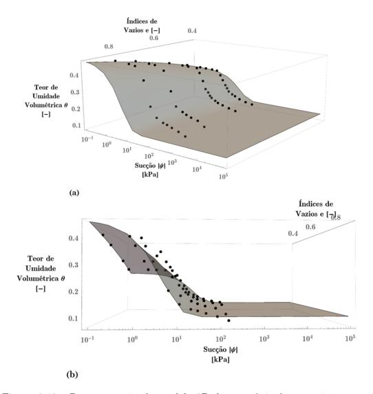
Figura 8.12 – Representação do modelo 3D de superfície de retenção para os dados de Chen (2018) em: (a) visão de canto e (b) visão lateral (a=0.68; b=1.90;  $\theta_r=0.10$ ).
