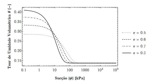
Figura 8.10 – Curvas de retenção relativas a diferentes índices de vazios obtidas a partir da superfície de retenção ( $a=0.78;\ b=2.95;\ \theta_r=0.14$ ).
