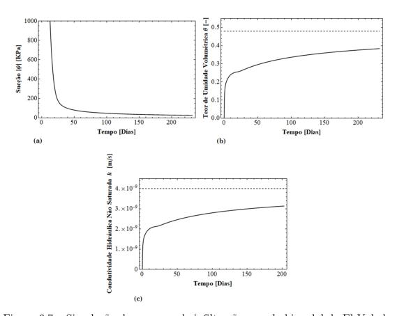
Figura 6.7 – Simulação do processo de infiltração no solo bimodal de El Volador após 200 dias em uma profundidade de 1 m ( $\lambda=0.46$ ;  $\delta_1=0.0220304~kPa^1$ ;  $\delta_2=0.00004~kPa^1$ ;  $k_s=4\times10^{-9}~m/s$ ;  $\theta_s=0.48$ ;  $\theta_r=0.0000047$ ;  $\psi_0=0~kPa$ ,  $\psi_i=-100.000~kPa$ , L=10m) expressando a relação entre: (a)  $|\psi|$  e tempo; (b)  $\theta$  e tempo e (c) k e tempo.
