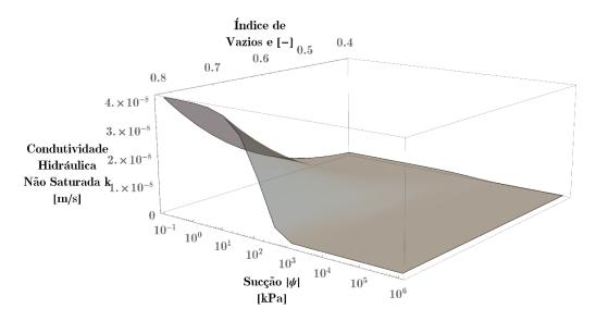
Figura 8.19 – Exemplo de superfície de condutividade hidráulica unimodal (a =
