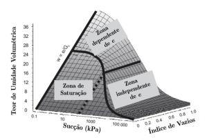
Figura 4.3 – Zonas na superfície de retenção de água no solo para uma areia silto-argilosa (modificado de Salager *et al.*, 2010).
