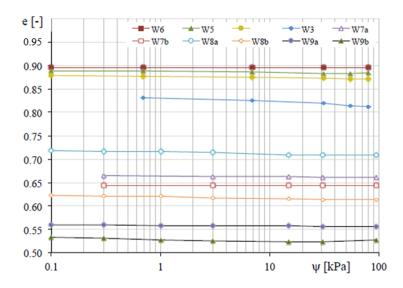
Figura 5.2 – Relação entre índice de vazios (e) e sucção  $(\psi)$  para o solo RMA a diferentes teores de umidade e pesos específicos (modificado de Quaglia, 2018).
