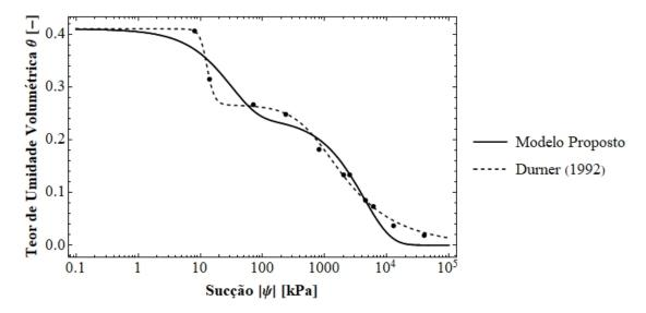
Figura 6.3 – Análise comparativa entre o modelo proposto e o modelo de Durner (1992) para o solo localizado em Barbosa.
