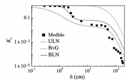
Figura 3.5 – Curvas de condutividade hidráulica não saturada bimodal previstas com base nos modelos ULN, BvG e BLN e dados de Mohanty et al. (1997) (modificado de Liu et al., 2013b).
