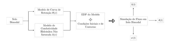
Figura 5.9 – Diagrama das etapas realizadas para a realização da simulação do fluxo em solo não saturado bimodal.
