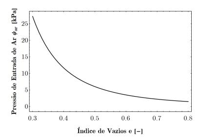
Figura 8.11 – Relação entre a pressão de entrada de ar e o índice de vazios para o solo RMA de Quaglia (2018).
