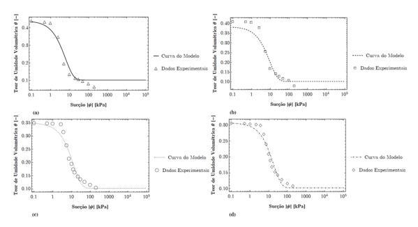
Figura 8.14 – Comparação entre a curva do modelo e os pontos experimentais de Chen (2018) para diferentes índices de vazios: (a) e = 0,786; (b) e = 0,698; (c) e = 0,538; (d) e = 0,444.
