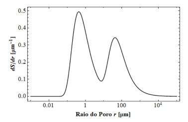
Figura 7.8 – Curva da função frequência de raios de um solo bimodal com superposição de regiões de poros ( $\theta_s=0.40,\;\theta_r=0.01,\;\delta_l=0.3\;\mathrm{kPa^{-1}},\;\delta_2=0.003\;\mathrm{kPa^{-1}},\;\lambda=0.40,\;\sigma=0.07275\cdot10^{-3}\;\mathrm{kN\cdot m^{-1}}$ ).
