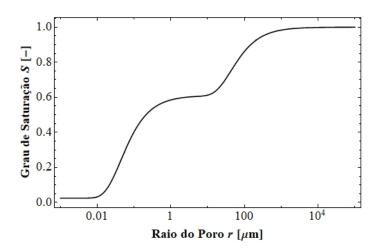
Figura 7.5 – Curva da função frequência acumulada de raios de um solo bimodal
