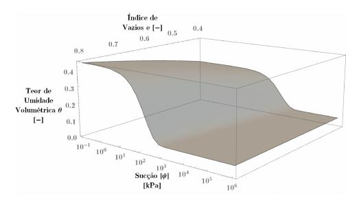
Figura 8.5 – Representação 3D do modelo de superfície de retenção unimodal (a = 10; b = 4;  $\theta_r$  = 0,05).
