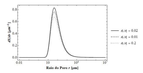
Figura 7.4 – Análise paramétrica de  $(\theta_r/\theta_s)$  na curva da função frequência de raios de um solo  $(\delta=0.3~\mathrm{kPa^{-1}},~\sigma=0.07275\cdot10^{-3}~\mathrm{kN\cdot m^{-1}}).$
