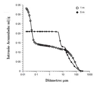
Figura 5.5 – Distribuição de poros acumulada do solo laterítico extraído a 1 m e a 5 m de profundidade (modificado de Futai & Almeida, 2005).
