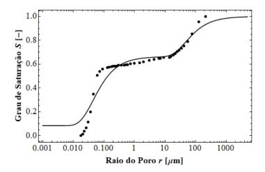
Figura 7.11 – Curva da função frequência acumulada de raios: comparação entre o modelo proposto de distribuição de poros bimodal e os dados experimentais de Futai & Almeida (2005) ( $\lambda = 0.37$ ,  $\delta_1 = 0.32875$  kPa<sup>-1</sup>,  $\delta_2 = 0.00031$  kPa<sup>-1</sup>,  $\theta_s = 0.60$ ,  $\theta_r = 0.05$ ).
