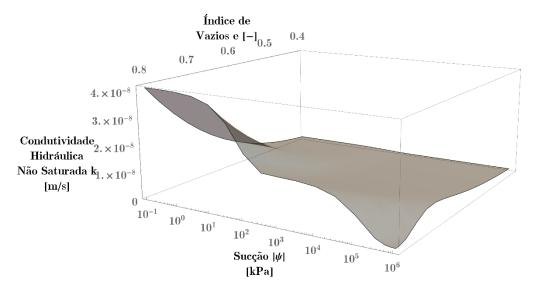
Figura 8.20 – Exemplo de superfície de condutividade hidráulica unimodal ( $a_1=100;\ b_1=25;\ a_2=10;\ b_2=1;\ \lambda=0,4;\ C=10^{-5}\ m/s;\ m=1,5$ ).
