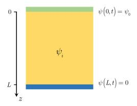
Figura 6.5 – Ilustração do processo de infiltração a ser simulado com a condição inicial e as condições de contorno.
