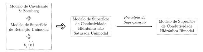
Figura 5.13 – Diagrama das etapas realizadas para a realização do desenvolvimento e da validação do modelo de superfície de condutividade hidráulica não saturada uni e bimodal.
