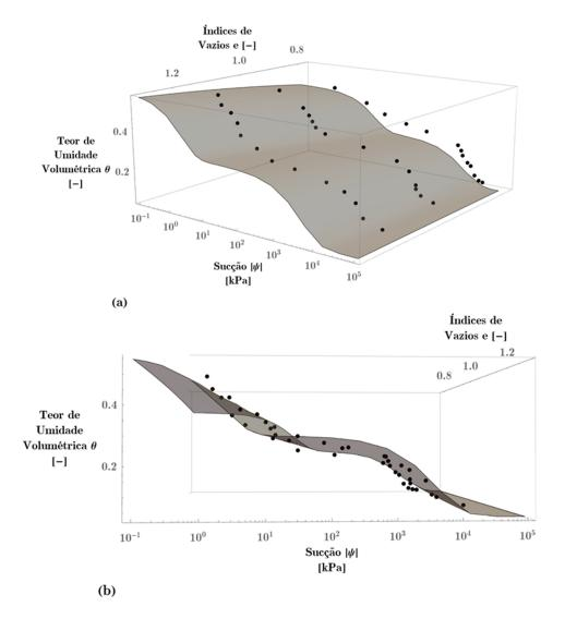
Figura 8.16 – Representação do modelo 3D de superfície de retenção para os dados de Silva (2009) em: (a) visão de canto e (b) visão lateral ( $a_1=1304,36;\ b_1=2,03;\ a_2=1,49;\ b_2=5,29;\ \lambda=0,51;\ \theta_\tau=0,03$ ).
