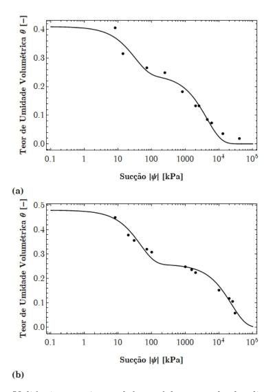
Figura 6.2 – Validação experimental do modelo para solos localizados em: (a) Barbosa ( $\lambda=0.41;\ \delta_1=0.03221\ kPa^1;\ \delta_2=0.00023\ kPa^1;\ \theta_s=0.41,\ \theta_r=0.0000033$ ) e em (b) El Volador ( $\lambda=0.46;\ \delta_1=0.0220304\ kPa^1;\ \delta_2=0.00004$   $kPa^1;\ \theta_s=0.48;\ \theta_r=0.0000048$ ).
