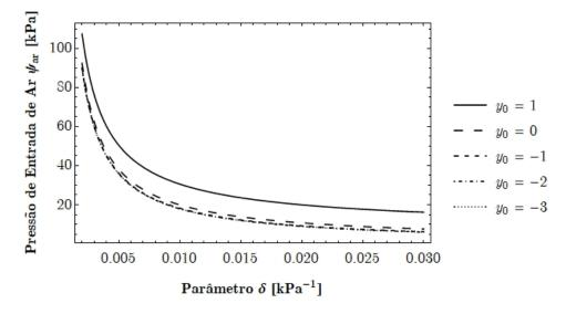
Figura 8.3 – Influência do  $y_0$  na curva que relaciona a pressão de entrada de ar $(\psi_{\rm ar}) \ {\rm e\ o\ parâmetro\ hidráulico}\ \delta.$
