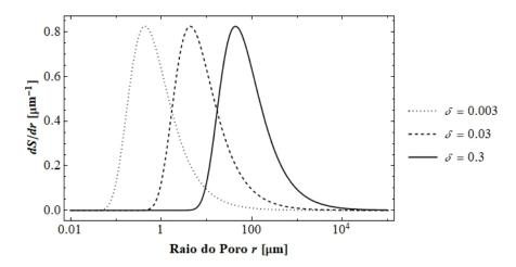
Figura 7.3 – Análise paramétrica do parâmetro  $\delta$  na curva da função frequência de raios de um solo ( $\theta_s = 0.40, \; \theta_r = 0.01, \; \sigma = 0.07275 \cdot 10^{-3} \; \text{kN} \cdot \text{m}^{-1}$ ).
