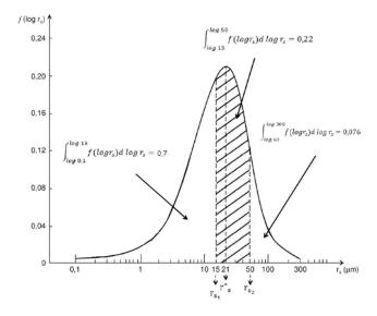
Figura 3.2 – Exemplo de curva da função frequência de raios (modificado de Libardi, 2010).
