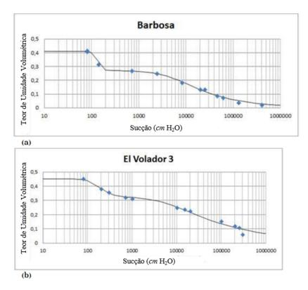
Figura 5.3 – Curvas de retenção bimodal ajustadas segundo o modelo de Durner (1992) para o solo presente em: (a) Barbosa e em (b) El Volador (modificado de Fresneda, 2019).
