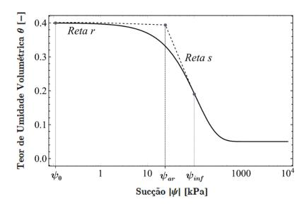
Figura 8.1 – Representação gráfica da pressão de entrada de ar fundamentada na interseção das retas r e s na curva de retenção de água no solo obtida por Cavalcante & Zornberg (2017a) ( $\delta = 0.09 \text{ kPa}^{-1}$ ;  $\theta_s = 0.40$ ;  $\theta_r = 0.05$ ).
