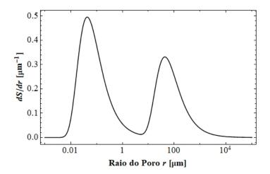
Figura 7.6 – Curva da função frequência de raios de um solo bimodal ( $\theta_s = 0.40$ ,  $\theta_r = 0.01$ ,  $\delta_l = 0.3$  kPa<sup>-1</sup>,  $\delta_2 = 0.0003$  kPa<sup>-1</sup>,  $\lambda = 0.40$ ,  $\sigma = 0.07275 \cdot 10^{-3}$  kN·m<sup>-1</sup>).
