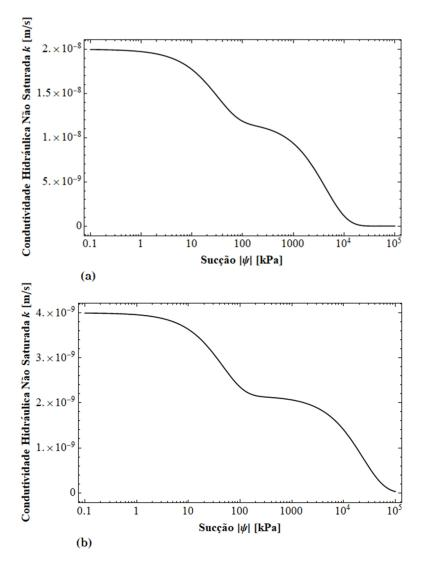
Figura 6.4 – Curva de condutividade hidráulica bimodal utilizando o modelo proposto e dados de: (a) Barbosa ( $k_s=2\times 10^{-8}~m/s;~\lambda=0,41;~\delta_1=0,03221~kN^{-1};$   $\delta_2=0,00023~kN^{-1}$ ) (b) El Volador ( $k_s=4\times 10^{-9}~m/s;~\lambda=0,46;~\delta_1=0,02203~kN^{-1};$   $\delta_2=0,00004~kN^{-1}$ ).
