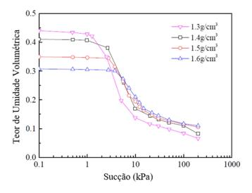
Figura 5.6 – Influência da densidade seca na curva de retenção do solo (modificado de Chen, 2018).
