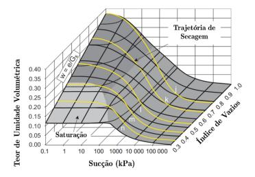
Figura 4.2 – Superfície de retenção de água no solo obtida para uma areia siltoargilosa (modificado de Salager *et al.*, 2010).
