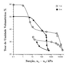
Figura 5.4 – Curvas de retenção de água do solo laterítico extraído a 1 m e a 5 m de profundidade (modificado de Futai & Almeida, 2005).
