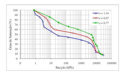
Figura 5.7 – Curva de retenção de água em função do grau de saturação volumétrica de um solo bimodal do distrito federal a diferentes índices de vazio (Silva, 2009).
