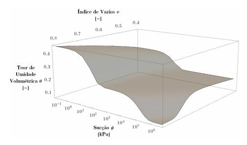
Figura 8.15 – Representação 3D do modelo de superfície de retenção bimodal ( $a_1$  = 100;  $b_1$  = 25;  $a_2$  = 10;  $b_2$  = 1;  $\lambda$  = 0,4;  $\theta_r$  = 0,05).
