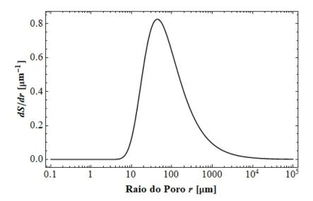
Figura 7.2 – Curva da função frequência de raios para um solo granular ( $\theta_s = 0.40, \ \theta_r = 0.01, \ \delta = 0.3 \ \text{kPa}^{-1}, \ \sigma = 0.07275 \cdot 10^{-3} \ \text{kN} \cdot \text{m}^{-1}$ ).
