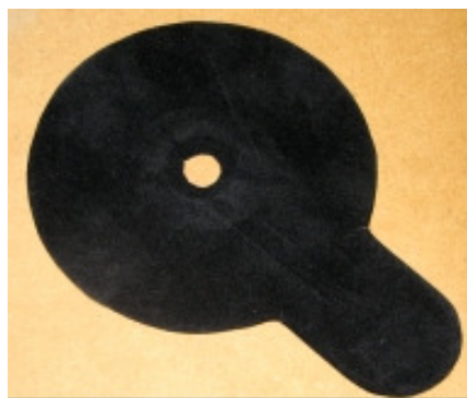
Figura 4.2 – Máscara negra utilizada entre a abertura do sensor e a amostra de madeira.
