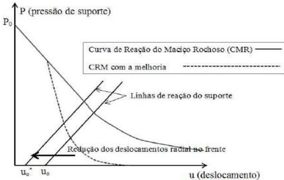
Figura 2.1. Curva de reação do maciço com e sem aplicação de melhoria (Oreste & Peila, 2001 apud Domingues, 2016).
