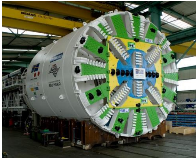
Figura 2.7. EPB utilizada na abertura dos túneis da Linha 4 do metrô de São Paulo (Assis, 2014a).
