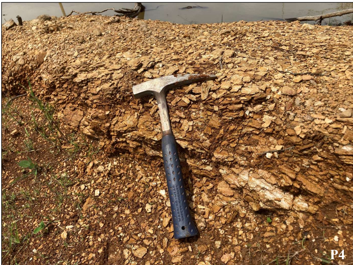
Figura 4.4: Rocha intemperizada do tipo Filito carbonoso. Fenômeno do empastilhamento
