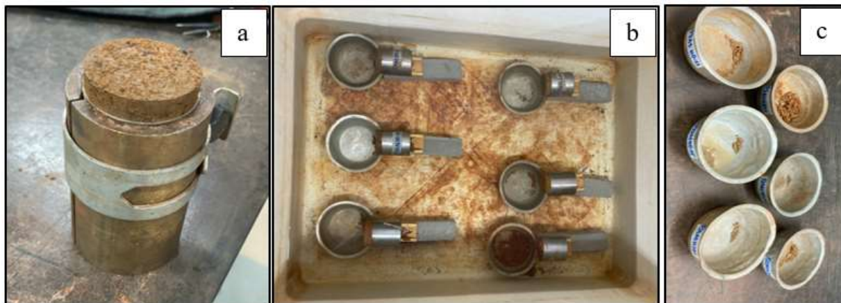
Figura 3.20: Ensaio de perda de massa por imersão. a) Saque de 10mm do corpo de prova; b) Submersão das amostras em água; c) massa despreendida após secagem em estufa.
