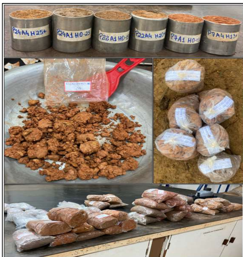
Figura 3.7: Amostras deformadas e indeformadas coletadas
