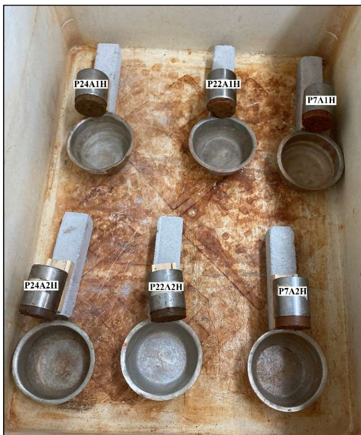
Figura 2.7: Amostras posicionadas para execução do ensaio de perda de massa por imersão
