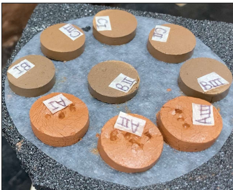
Figura 3.13: Pastilhas após penetração com penetrômetro padrão
