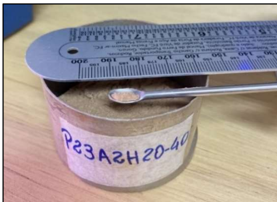
Figura 3.16: Amostra utilizada para realizar o ensaio de granulometria a laser
