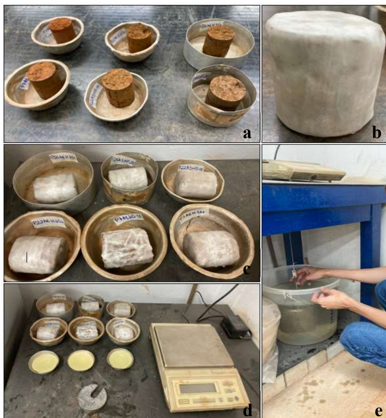
Figura 3.19: Ensaios de massa específica aparente: a) amostras indeformadas; b) e c) preparação das amostras; d) e e) pesagem das amostras em balança hidrostática
