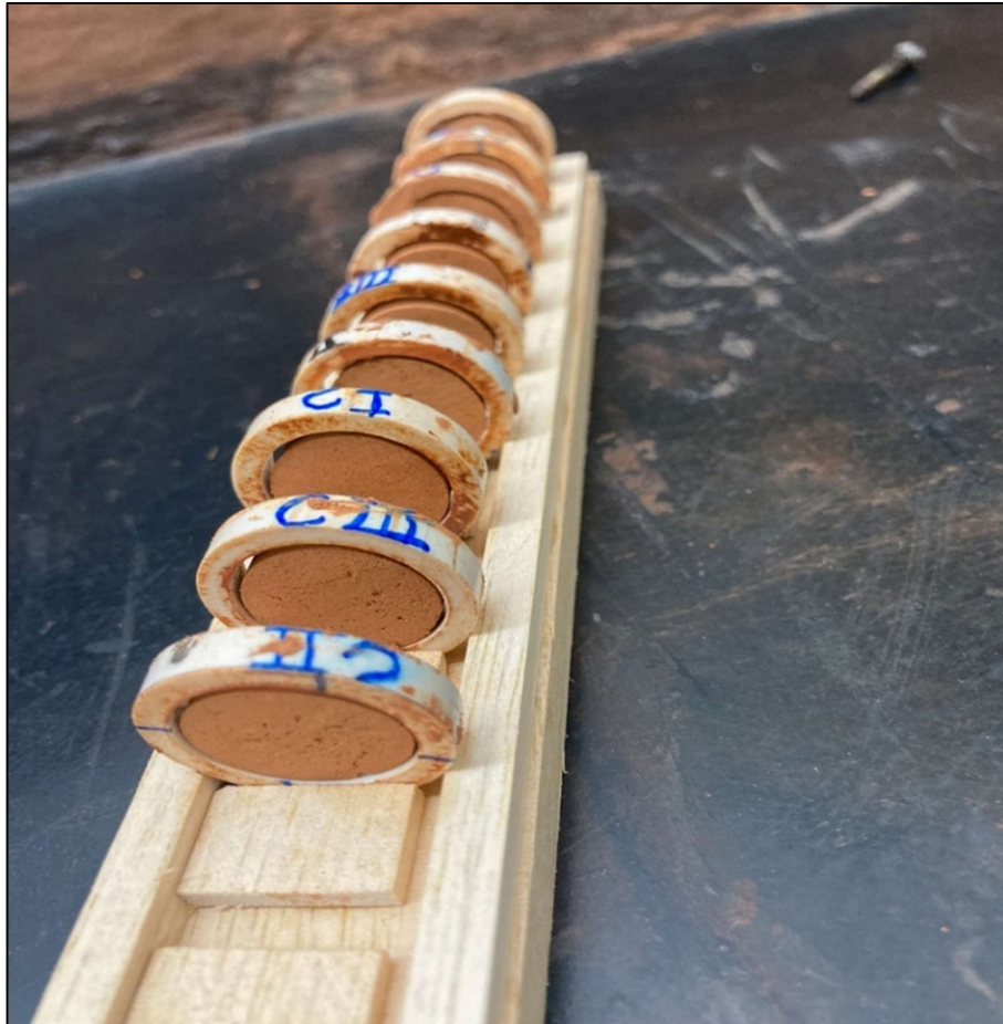
Figura 3.10: Secagem das pastilhas moldadas nos anéis de PVC em suporte vertical
