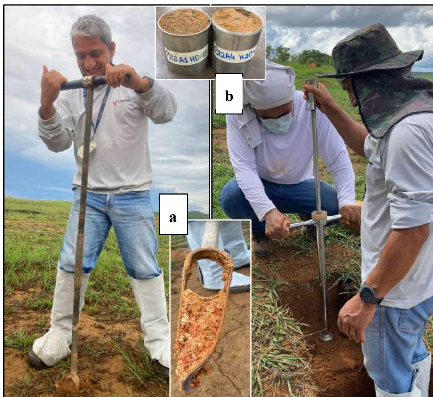
Figura 3.6: Coleta de amostras com a) trado holandês e b) amostrador de amostra indeformáveis tipo copo ou caneco
