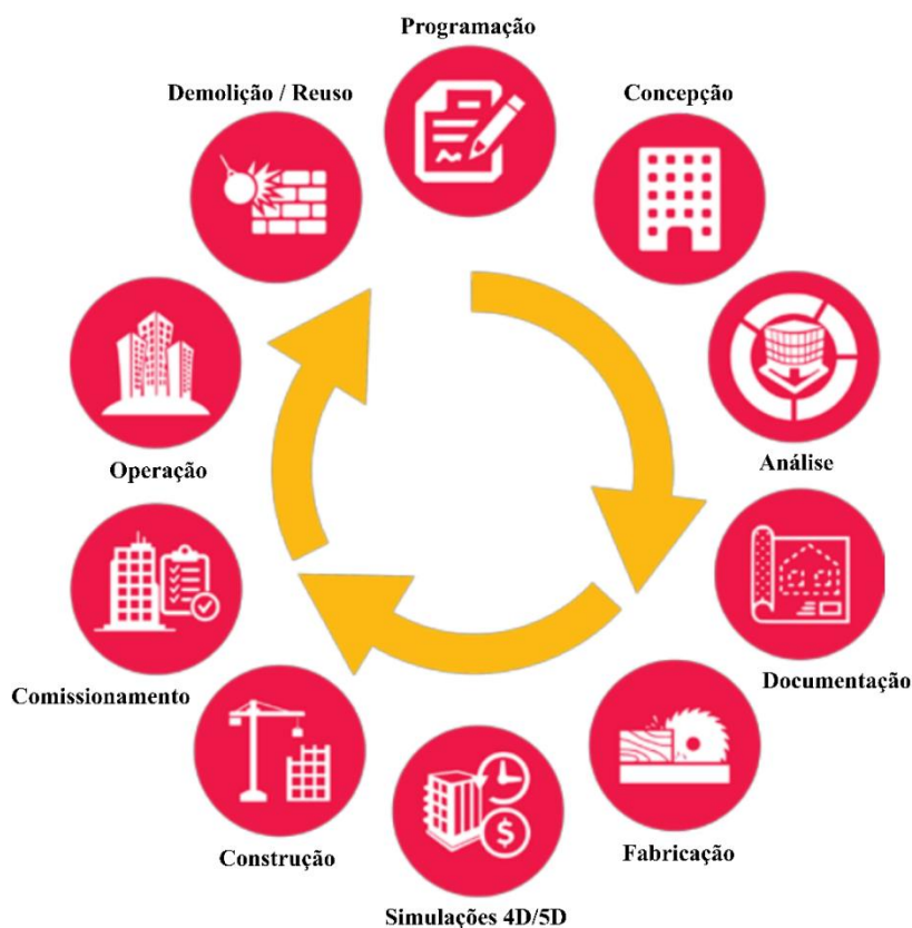
Figura 2.8 - BIM no ciclo de vida das edificações
