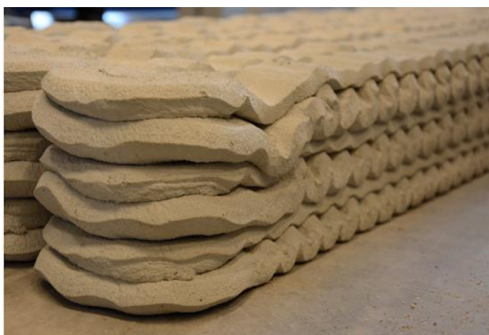
Figura 17 – Camadas de impressão 3D em concreto
