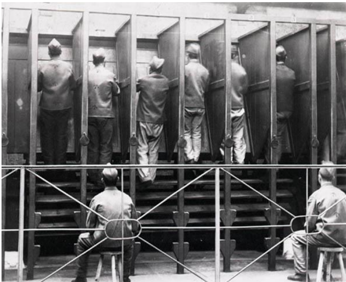
Fotografia 10 – Prisioneiros em um moinho horizontal, ou “escada perpétua” na Penitenciária de Pentonville, 1895.
