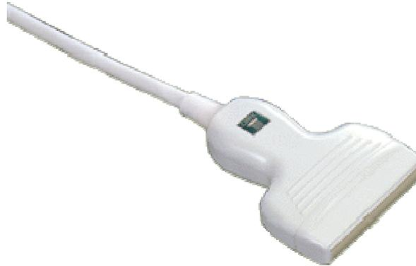
Figura 7. Modelo de transdutor de equipamento de ultra-sonografia.
