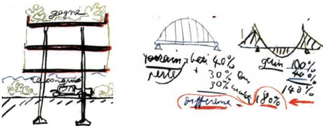
Figura 2-4 - Croquis de Corbusier. A esquerda um corte representando o solo livre com os pisos elevados, a direita uma representação do cálculo dos esforços que mostra que a primeira viga (de uma edificação com paredes em pedras) opera em duas vezes mais desfavorável que uma edificação em balanço construída em concreto armado.
