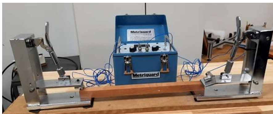
Figura 21. Equipamento Stress Wave Timer utilizado para obtenção da velocidade de propagação sonora e módulo de elasticidade dinâmico (MOEd) para as sete espécies de madeiras da Amazônia brasileira.
