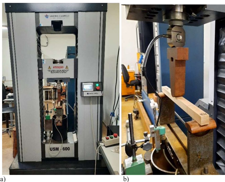
Figura 22. a) Máquina de Ensaio USM 600 utilizada para realização dos ensaios de flexão estática reduzida (ASTM D - 143); b) Detalhe do posicionamento do corpo de prova e da aplicação da carga entre dois apoios.
