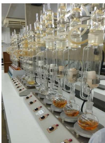
Figura 17. Processo de extração em Etanol-Tolueno (1:2), conforme a norma TAPPI T 204, em extrator Soxhlet para estimar o teor de extrativos das sete espécies de madeiras da Amazônia brasileira.
