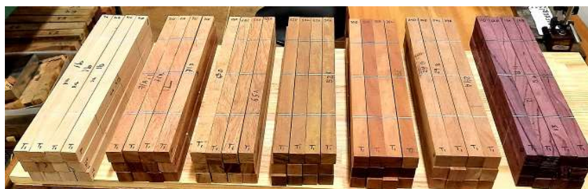
Figura 19. Corpos de prova utilizados para realização dos testes acústicos em equipamentos não destrutivos e no ensaio de flexão estática das sete espécies de madeiras da Amazônia brasileira.
