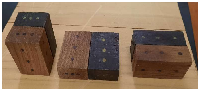
Figura 14. Pontos marcados nos corpos de prova, nas três faces da madeira, utilizados como referência nas medições da estabilidade dimensional em diferentes teores de umidade da madeira.
