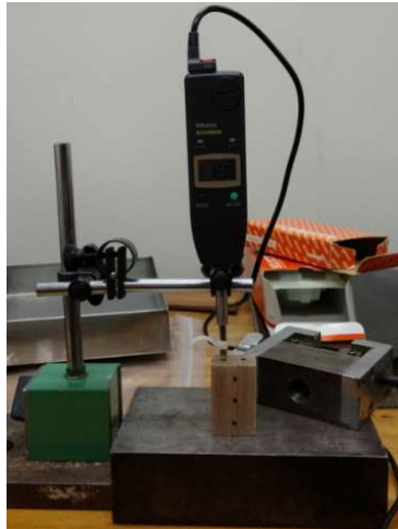
Figura 15. Medições efetuadas para o cálculo da retratibilidade da madeira com uso de relógio comparador com resolução de 0,01mm, de acordo com a Norma NBR 7190.
