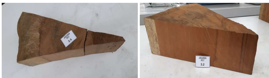
Figura 16. Cunhas de discos de madeiras de duas espécies, cedrinho e tamarindo, utilizadas no estudo, com porção representativa de cerne e alburno, para caracterizar o teor de extrativos em etanol:tolueno (Fotos: Dhébora Juliana Lino Pires).
