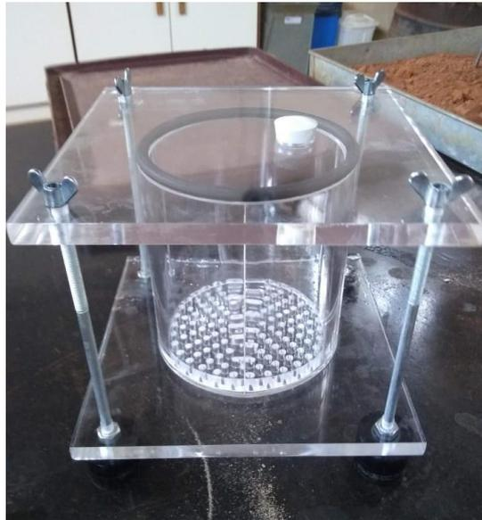
Figura 3.10 - Tipo de célula utilizada nos ensaios de difusão.
