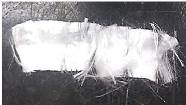
Figura 3.3 – Fibras de polipropileno utilizadas na pesquisa.
