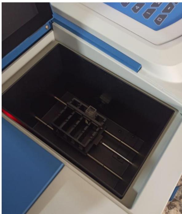
Figura 3.17 - Cubeta de quartzo acoplada ao espectrofotômetro.
