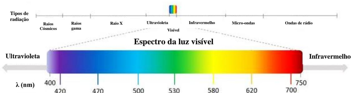
Figura 2.18 - Faixa de frequências do espectro eletromagnético (Fonte: modificado de HEESUNG SHIM, 2017).
