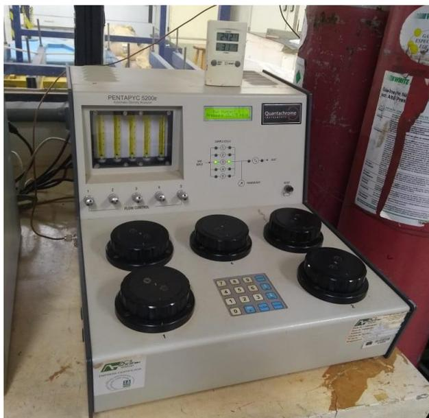
Figura 3.7 - Pentapicnômetro do laboratório de Geotecnia da UnB.
