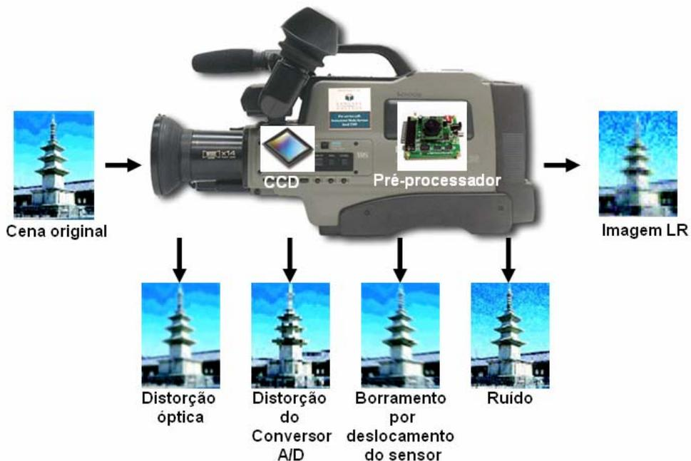
Figura 2.2 - Sistema de aquisição de imagens, adaptado de (Park *et al.*, 2003).
