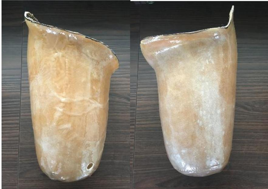
Figura 38. Soquete de látex (Modelo 1) resinado após acabamento.
