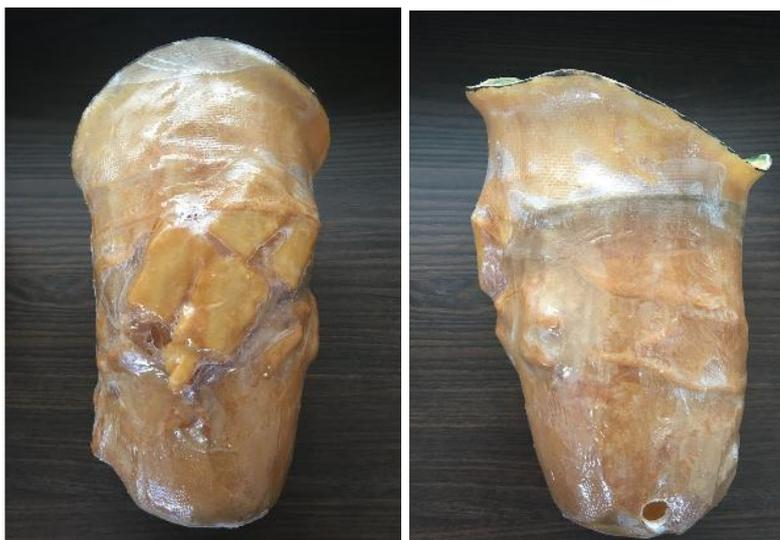
Figura 45. Soquete Modelo 2 resinado após acabamento.
