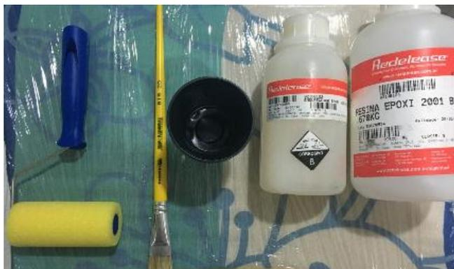
Figura 26. Materiais utilizados para os testes com resina e fibra de vidro.
