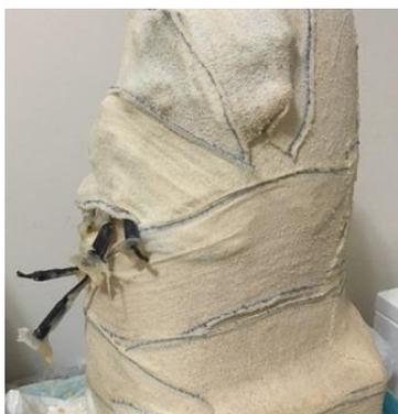
Figura 47. Cobertura do Modelo 3 com atadura crepe banhada em látex.
