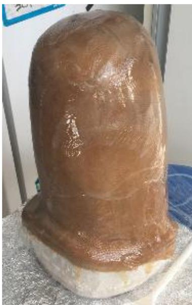
Figura 36. Soquete de látex após cobertura de resina epóxi e fibra de vidro
