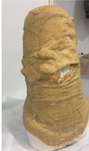
Figura 48. Soquete de biomaterial látex após finalização das camadas.
