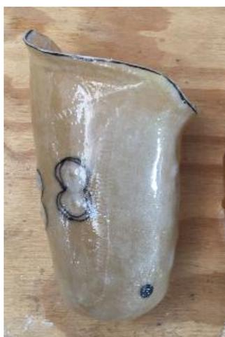
Figura 53. Soquete Modelo 4 resinado com marcações dos cortes nos locais de inserção de eletrodos.
