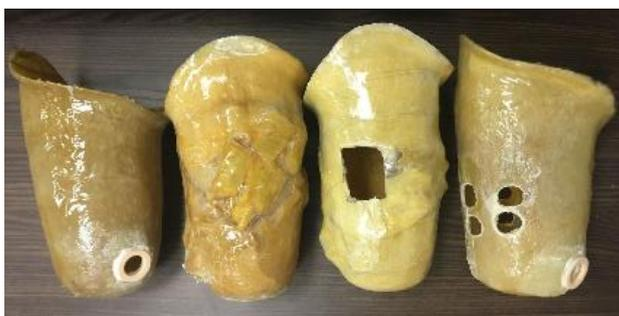
Figura 64. Soquetes desenvolvidos. Da esquerda para a direita: Modelo 1, Modelo 2, Modelo 3 e Modelo 4.
