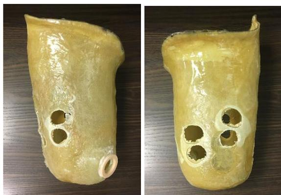
Figura 72. Soquete Modelo 4 com orifícios para posicionamento de eletrodos.
