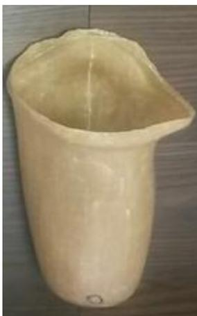
Figura 24. Soquete de biomaterial látex - protótipo 3 (tamanho real).
