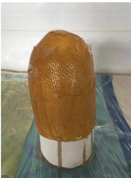
Figura 28. Protótipo 1 de biomaterial látex recoberto de resina epóxi com endurecedor e tecido bidirecional de fibra de vidro.
