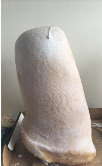
Figura 34. Molde após cobertura com tecido e durante vulcanização de camada de látex.
