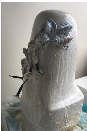
Figura 46. Molde positivo de gesso com Eletrodos e cabos com conectores do tipo jacaré replicados em material de baixo custo posicionados.
