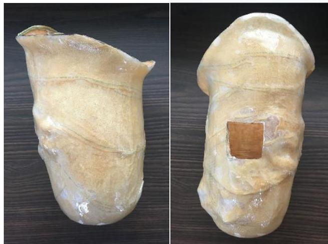
Figura 49. Soquete Modelo 3 resinado após acabamento.
