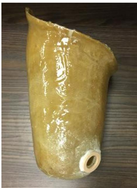
Figura 63. Soquete Modelo 1 com válvula de sucção instalada.
