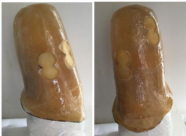
Figura 61. Orifícios fechados com biomaterial látex no soquete Modelo 4.
