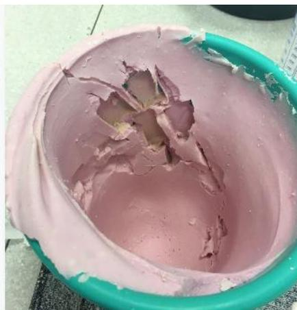
Figura 40. Molde negativo em alginato com as impressões dos sensores posicionados no coto.
