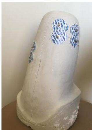
Figura 50. Molde positivo com eletrodos posicionados.
