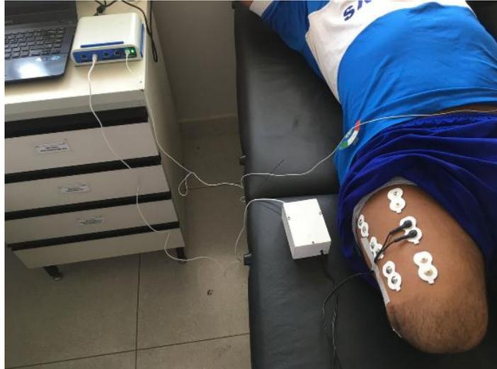
Figura 59. Teste com proposta de extensão. Sinal sendo captado do músculo Reto Femoral do coto residual.
