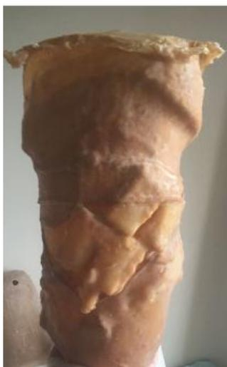
Figura 44. Soquete de biomaterial látex após finalização das camadas.
