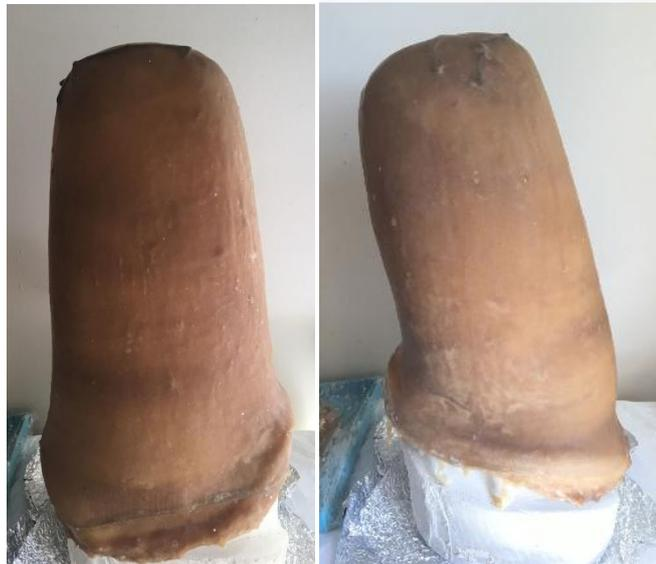
Figura 35. Soquete de látex após finalização das camadas e descanso de 24h.
