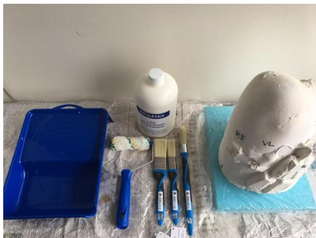
Figura 42. Materiais utilizados para cobertura de biomaterial látex.
