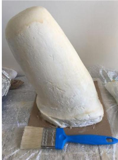
Figura 32. Cobertura inicial do molde positivo de gesso com biomaterial látex.
