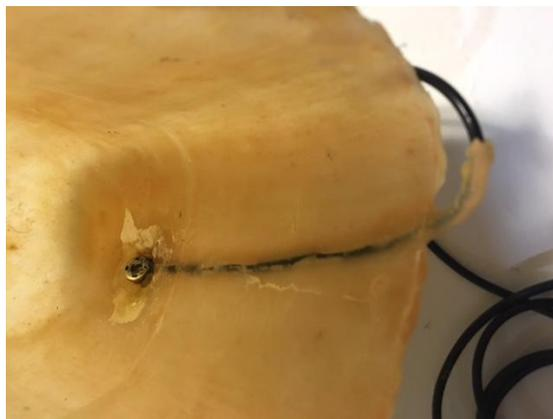
Figura 31. Vista interna do protótipo 4 com visualização da integração do conector para o eletrodo.
