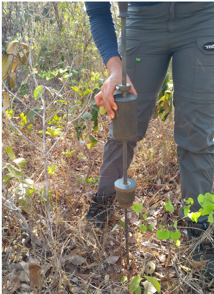
Figura 4: Aferição com penetrômetro de impacto.
