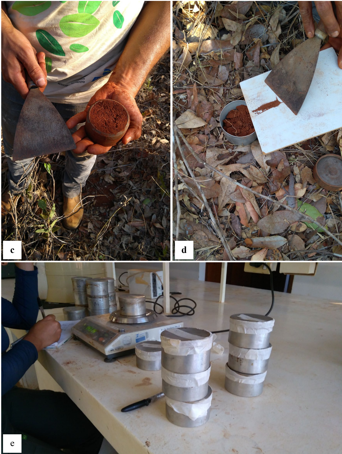
Figura 5: Procedimento de análise de densidade do solo. (a) Introdução do anel volumétrico. (b) Retirada do anel volumétrico. (c) Retirada do excesso de solo do anel volumétrico. (d) Amostra de solo sendo guardada em latas específicas. (e) Amostras sendo pesadas.
