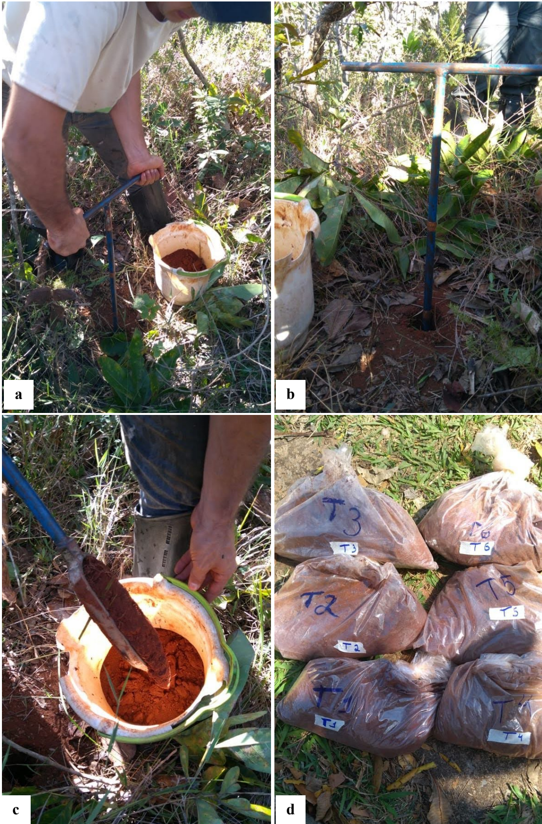
Figura 6: Procedimento de coleta de solos para análises químicas e físicas. (a) Manuseio do trado. (b) Conferência da profundidade. (c) – Homogeneização das subamostras para a composição da amostra composta. (d) Amostras separadas e identificadas.
