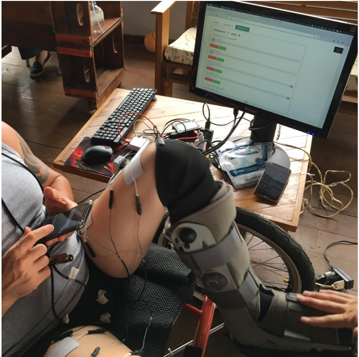
Figura 4.2: São apresentados dois canais do estimulador, o sensor inercial anexado ao pedivela, o celular do paciente e um monitor conectado a Raspberry.
