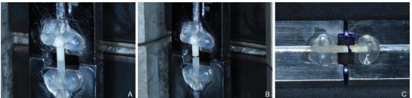
Figura 19 – Palito submetido ao teste. (A) palito pré-fratura. (B) palito pós-fratura. (C) vista superior do palito pós-fratura.
